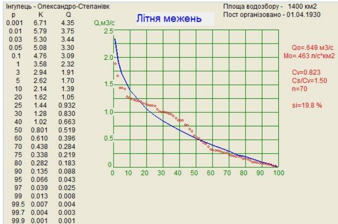
Рисунок 2.14 – Емпірична і теоретична криві забезпеченості трьох-параметричного гамма розподілу розрахованого методом найбільшої правдоподібності для літньої межні для річки Інгулець – пост Олександр-Степанівка
