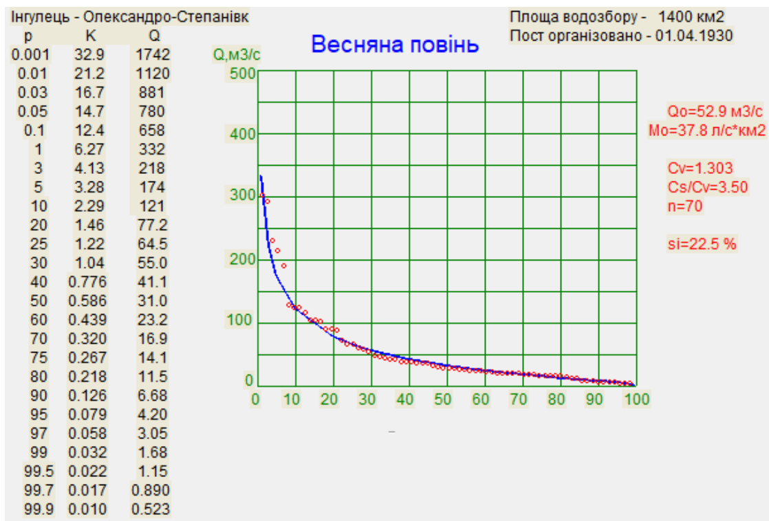
Рисунок 2.13 – Емпірична і теоретична криві забезпеченості трьох-параметричного гамма розподілу розрахованого методом найбільшої правдоподібності для весняної повені для річки Інгулець – пост Олександр-Степанівка
