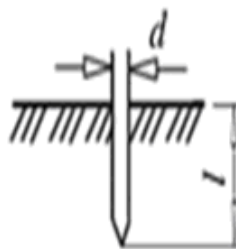
Рис. 8.1. Конструкція заземлювача – труба біля поверхні землі.
