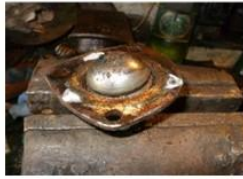
Абразивне зношування й корозія кульового пальця й корпуса кульового шарніра
