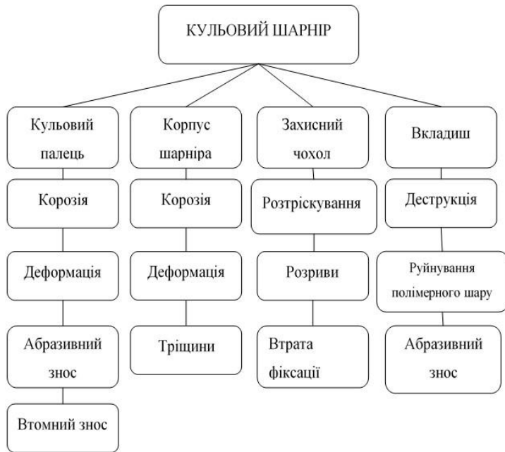
Відмови деталей кульового шарніра
