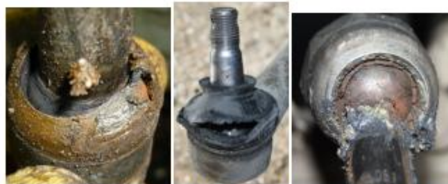
Рис. 2. Стан кульових опор та наконечників рульового керування
