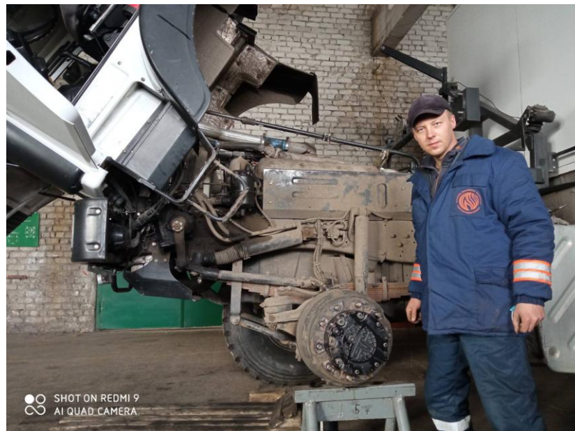
Рис. 3.4. установка наконечників тяг на автомобіль
