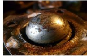
Абразивне зношування й корозія кульового пальця й корпуса кульового шарніра
