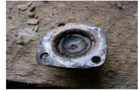
Абразивне зношування вкладиша
