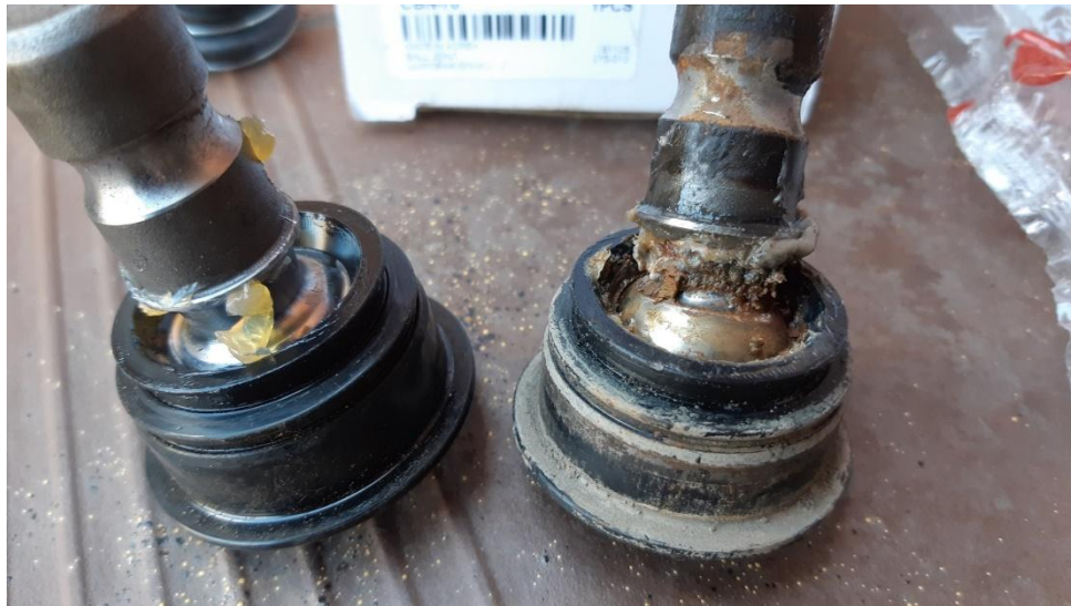
Рис. 2.1. Фото нової та опори яка має граничний стан
