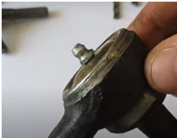
Рис. 2.5. Модернізація опори встановленням прес-маслянки
