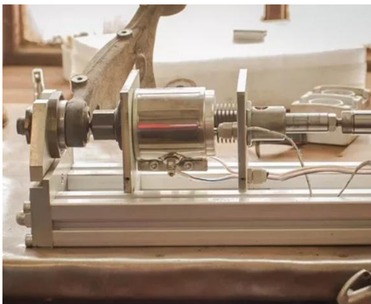
Рис. 2.3. Термопрес для відновлення кульових опор
