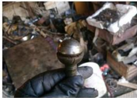
Абразивне зношування кульового пальця у вигляді радіальних канавок на сферичній поверхні
