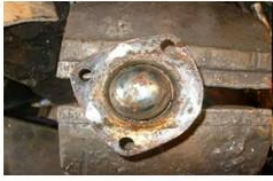
Абразивне зношування й корозія кульового пальця й корпуса кульового шарніра
