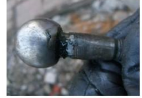
Абразивне зношування сферичної головки й втомне зношування в перехідній частині кульового пальця
