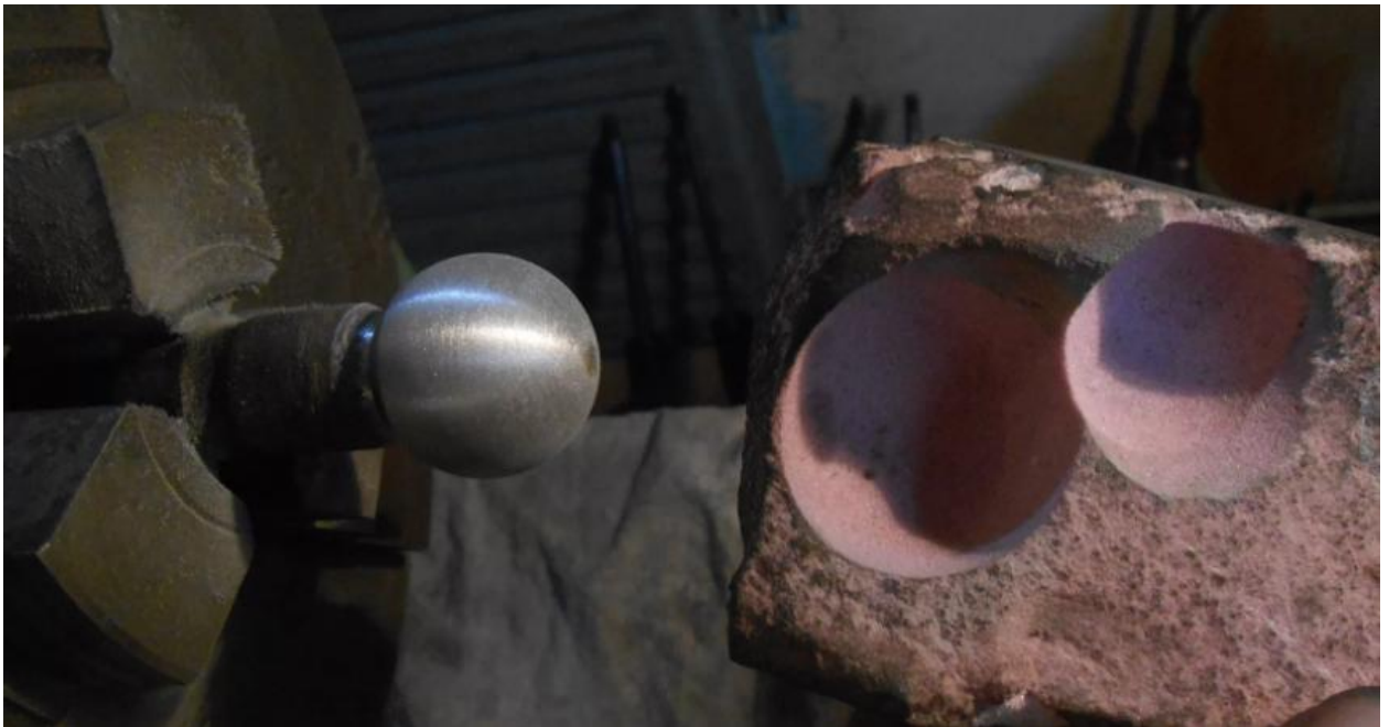
Рис. 2.4. Шліфування пальців опори
