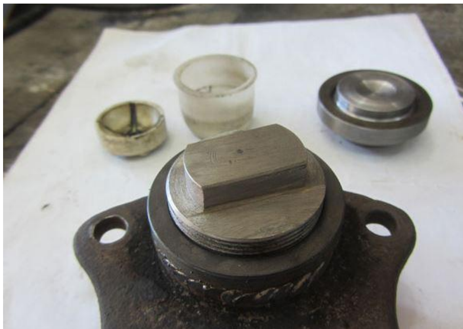
Рис. 2.2. Модернізація кульового шарніра
