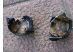
Підвищення температури, що викликає плинність і перетворення молекул полімеру в газоподібний стан у поверхневих шарах при русі пальця навколо вкладиша із тертя - деструкція
