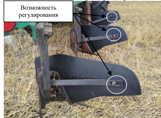
Рисунок 1 – Плуг, укомплектованный экспериментальными отвалами.
