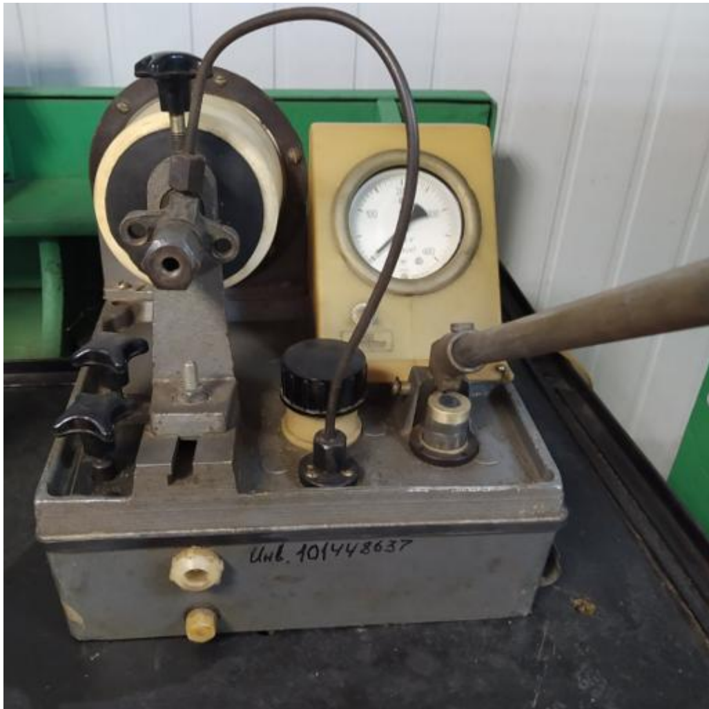
Рис. 3.6. Настроювання гідроаккумулятора експериментальної установки на приладі КИ 15706
