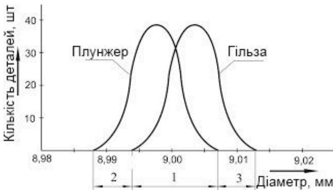
Рис.2.4. Розподіл розмірів плунжера й гільзи після перешліфування
