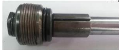
Пружинний вкладиш на оправленні після круглого шліфування
