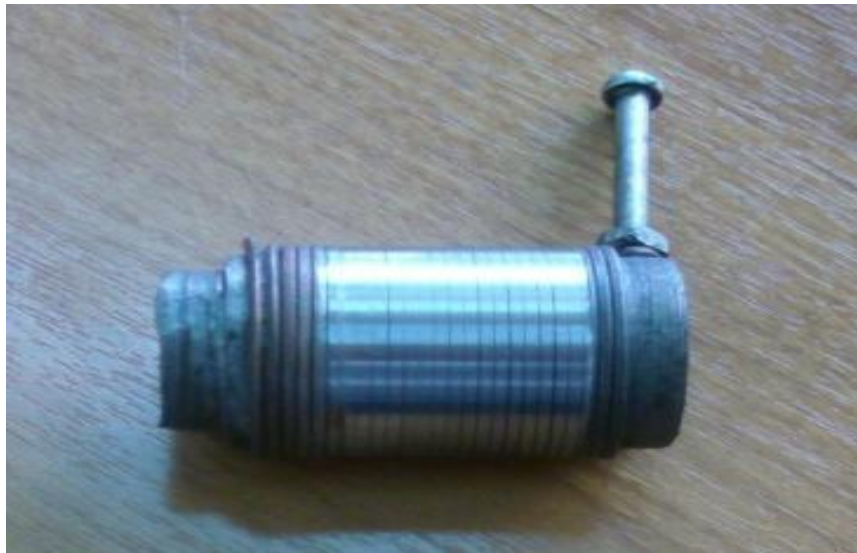
Рис. 3.4. Пружинний вкладиш на оправленні після круглого шліфування
