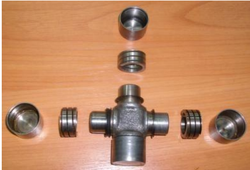
Рис. 3.18. Удосконалена хрестовина автомобіля ВАЗ «Нива»
