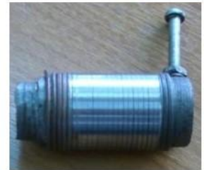
Пружинний вкладиш на оправленні після круглого шліфування
