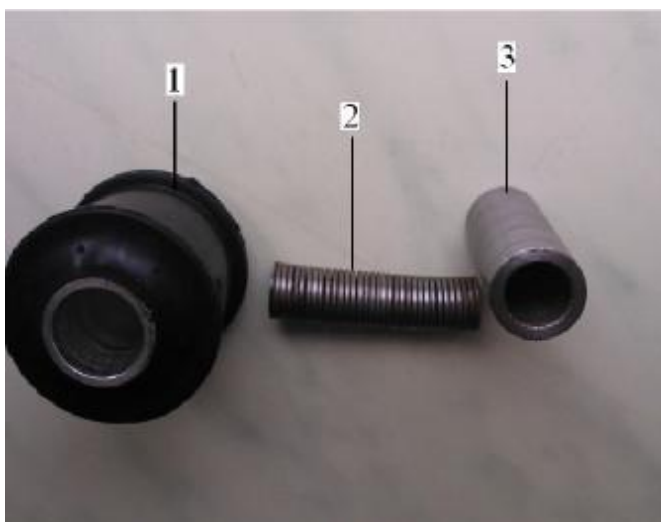
Рис. 3.11. Ремонтний комплект деталей для інноваційного сайленблока 1 – сайленблок, 2 – конічний пружинний вкладиш, 3 – сталева втулка
