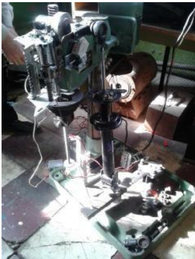
Рис. 3.6. Експериментальна установка самостійного виготовлення для дослідження амортизаторів по зусиллю стиску й відбою
