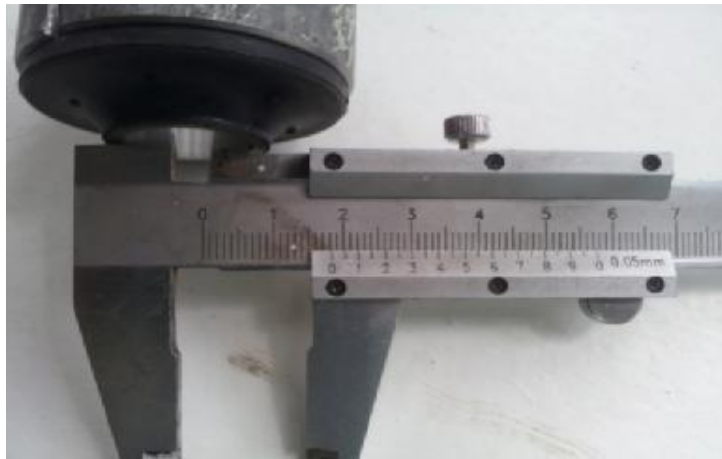
Рис. 3.9. Розточений внутрішній діаметр алюмінієвої втулки сайленблока
