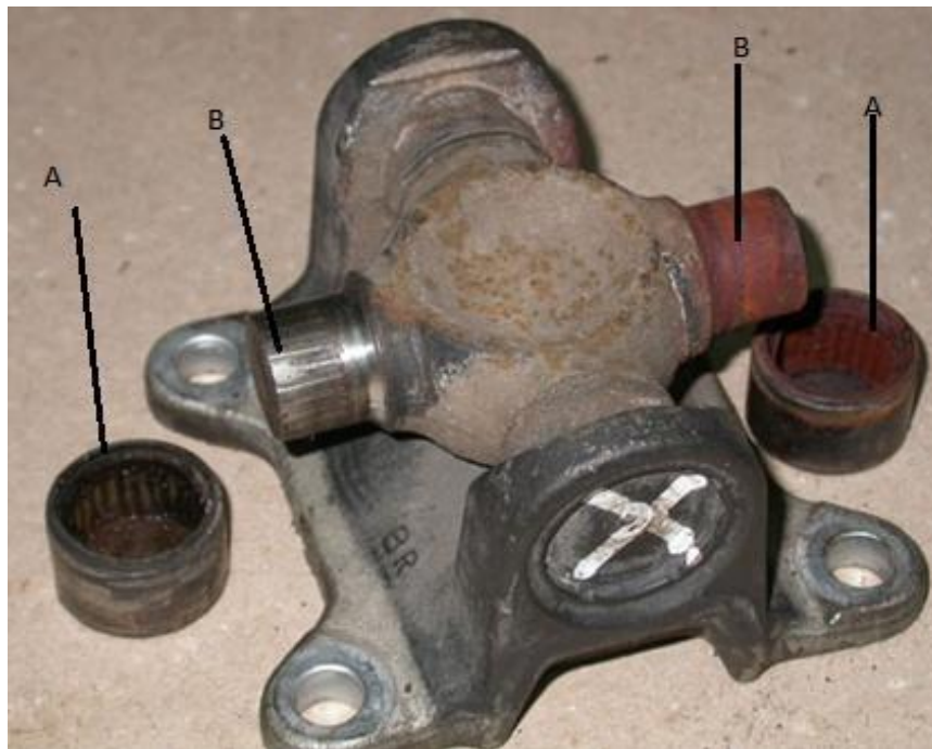
Рис. 3.17. Зовнішній вигляд зношених деталей підшипникового вузла хрестовини
