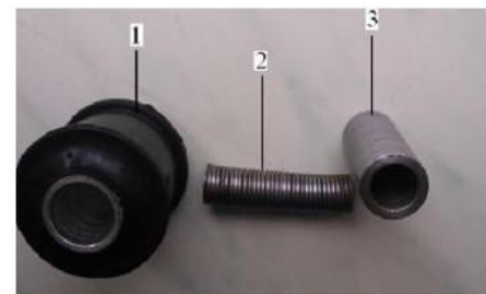
Ремонтний комплект деталей для інноваційного сайлентблока: 1 – сайлентблок, 2 – конічний пружинний вкладиш, 3 – сталевая втулка
