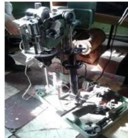
Експериментальна установка самостійного виготовлення для дослідження амортизаторів по зусиллю стиску й відбою
