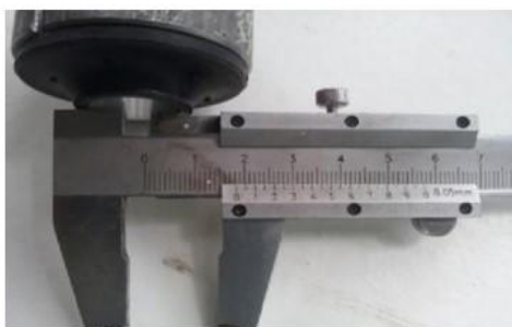
Розточений внутрішній діаметр алюмінієвої втулки сайлентблока
