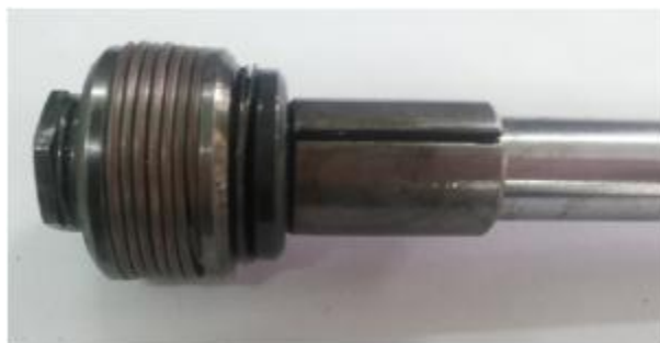
Рис. 3.5. Поршень у зборі з ущільнювальним обмідненим пружинним вкладишем
