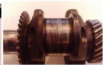
Сліди схватування матеріалу шатуна з шийкою колінчатого валу
