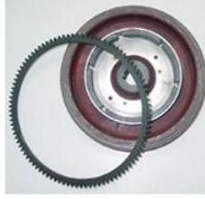
Двигун не заводиться. Не закріплений зубчатий вінець маховика
