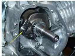
Застукав двигун. Знос шийки колінчатого валу.
