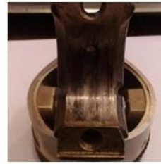
Інтенсивний знос нижньої головки шатуна
