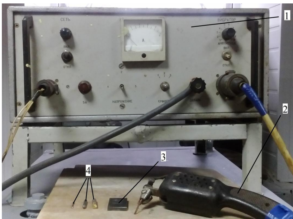
Рис. 3.2. Установка электроіскрового легування «Елітрон-20»: 1 – генератор; 2 – вібробудник; 3 – експериментальний зразок; 4 – електроди.
