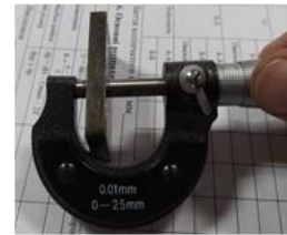
Вимірювання товщини наплавленого шару
