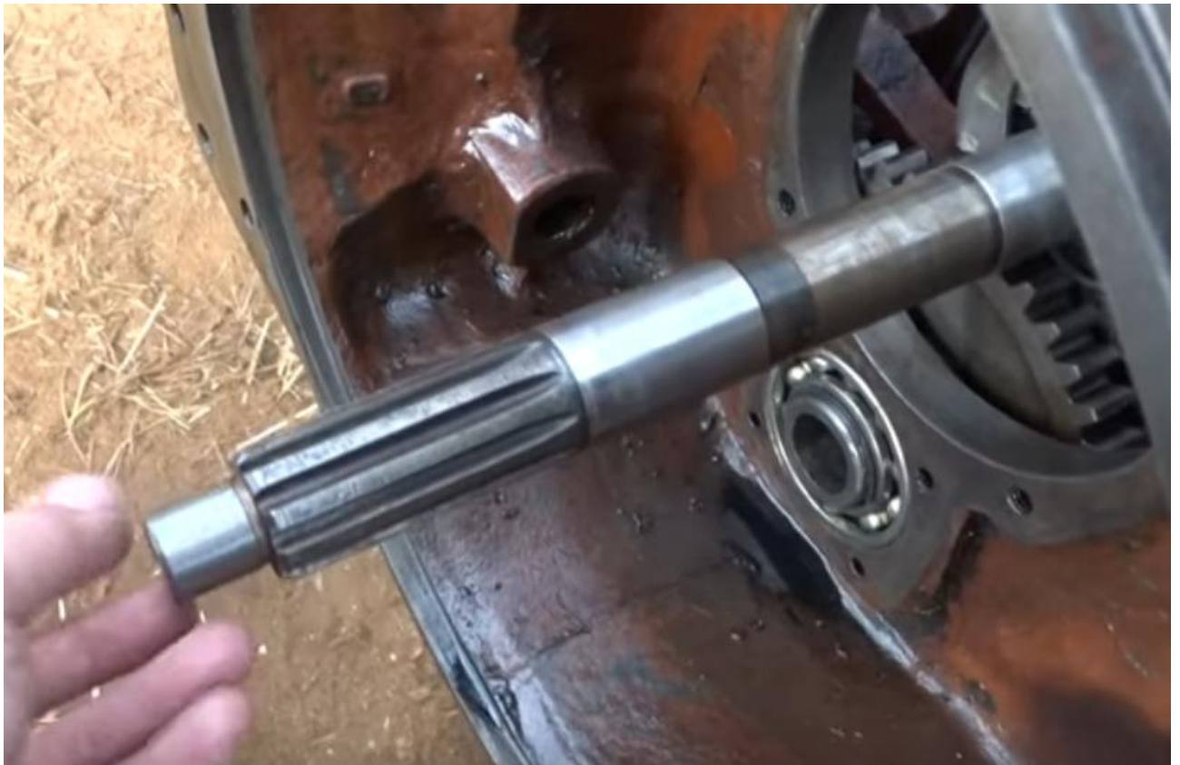
Рис. 2.5. Вал після відновлення та шліфування
