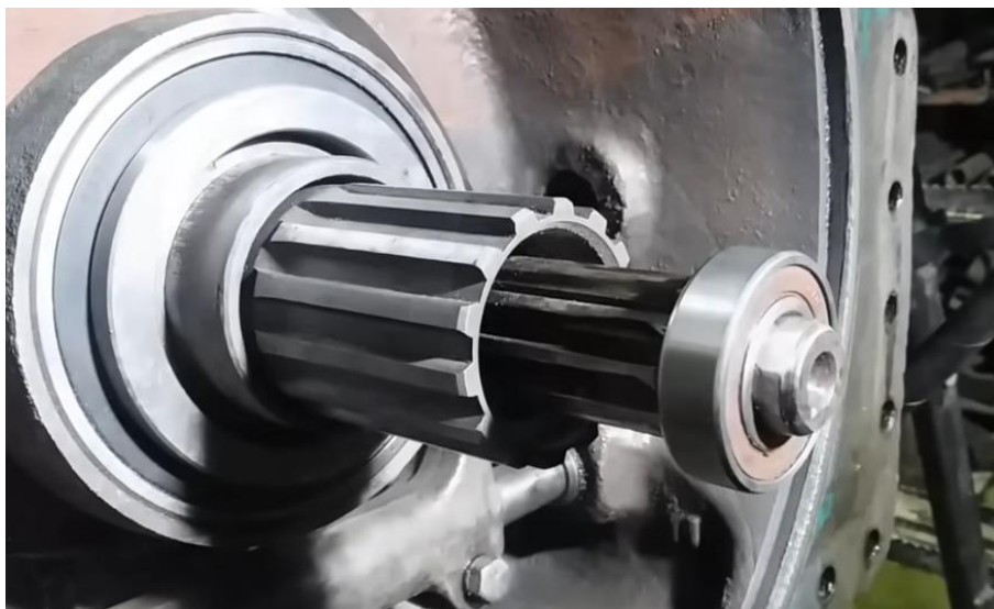
Рис. 2.2. Зняття підшипника, що провернувся
