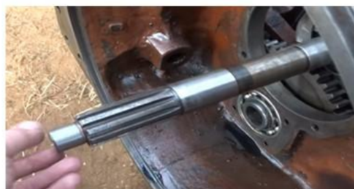
Вал після відновлення та шліфування
