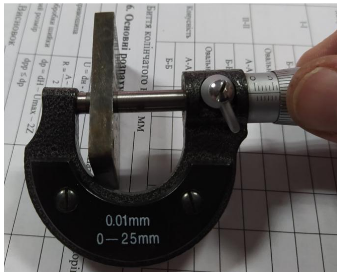
Рис. 3.7. Вимірювання товщини наплавленого шару
