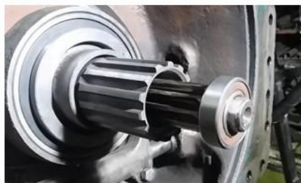
Зняття підшипника, що повернувся
