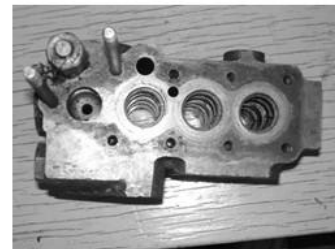
Зовнішній вид зносу посадочних отворів корпуса розподільника
