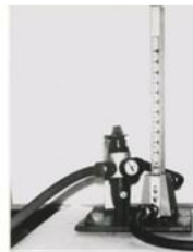
Пристрій для діагностування розподільників стисненим повітрям схема підключення при діагностуванні
