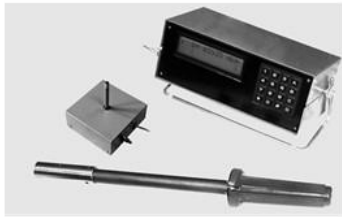
Замір отворів корпусу розподільника
