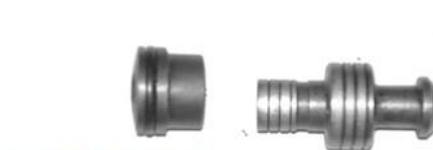
Зовнішній вид зносу поверхонь перепускного клапану
