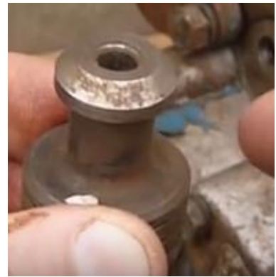
Рис. 1.9. знос та корозія перепускного клапана
