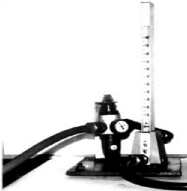
Фото 3.10. Загальний вигляд установки для контролю витрат стисненого повітря
