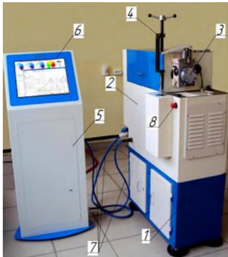
Рис. 3.11 – Загальний вид машини тертя СМТ-1М: 1 – підставка; 2 – станина; 3 – випробувальна камера; 4 – механізм навантаження; 5 – термінал для збору інформації; 6 – екран для виведення інформації; 7 – силові електропроводи; 8 – кнопка аварійного відключення
