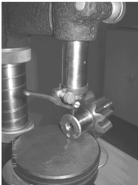
Рис. 3.4 – Вимірювання цапф шестерень в двох площинах та двох поясах (рис. 3.4)
