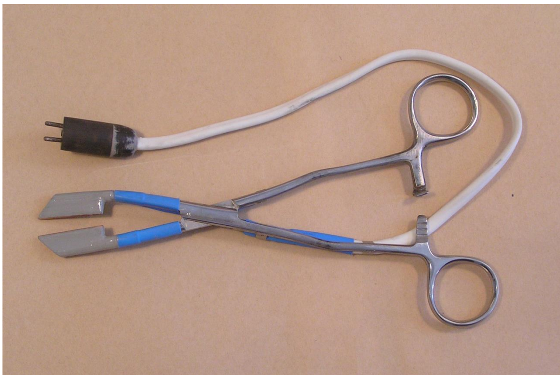
Рисунок 5. - Інструмент для «різки» тканин
