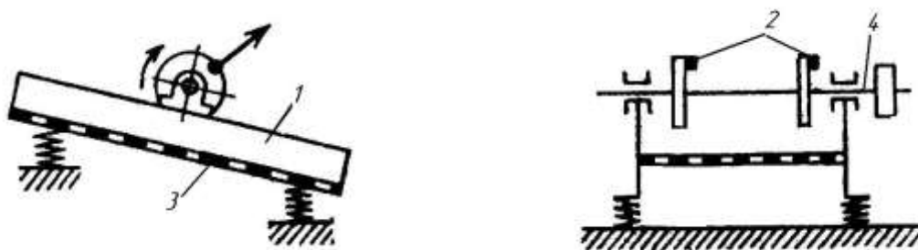
1 – корпус; 2 – дебаланси; 3 – сито; 4 – вал
