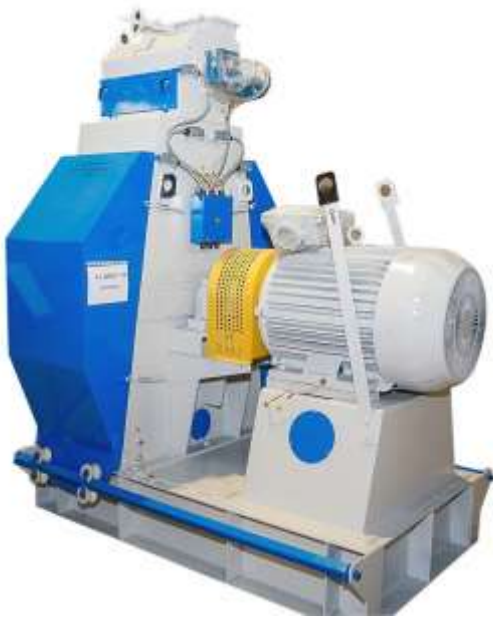
Рисунок 1.22 – Схема та загальний вигляд молоткових дробарок типу ДМ.
