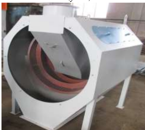
Рисунок 3.14 – Схема, загальний вигляд барабанного скальператора та ситового барабана
