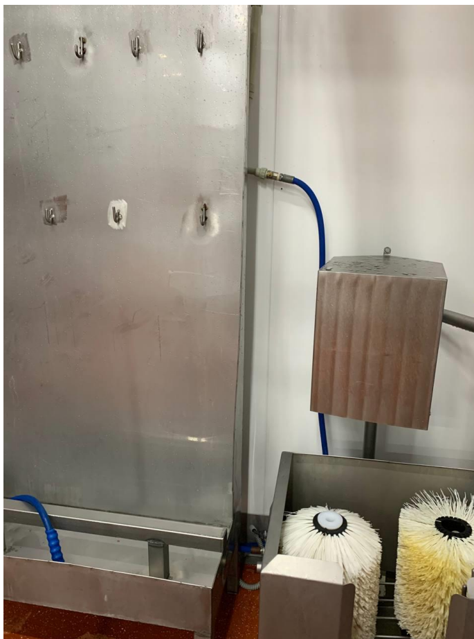
Рис. 15. Апарат для миття та дезінфекції чобіт перед входом та виходом із виробничого відділу
