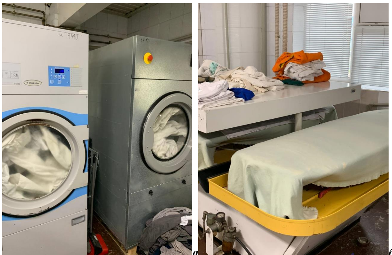
Рис. 14. Пральні машини цеху забою (а) і сушильні преси (б)
