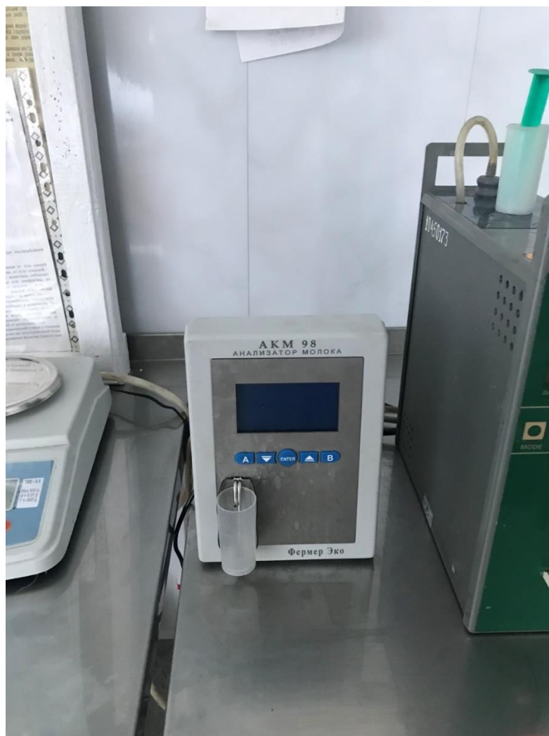
Рис. 4. Ультразвуковий аналізатор молока «Фермер еко»
