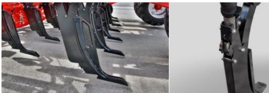
Рисунок 2.7 – Розпушувальні лапи-стійки з патрубком подачі добрив
