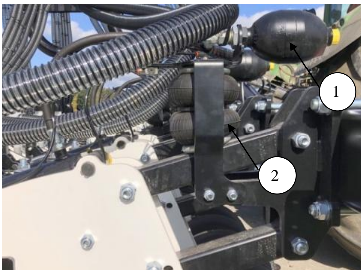
Рисунок 2.5 – Елементи захисту та регулювання секції Stripcat II: 1) – гідравлічний акумулятор гідроциліндра; 2) – пневмокамера
