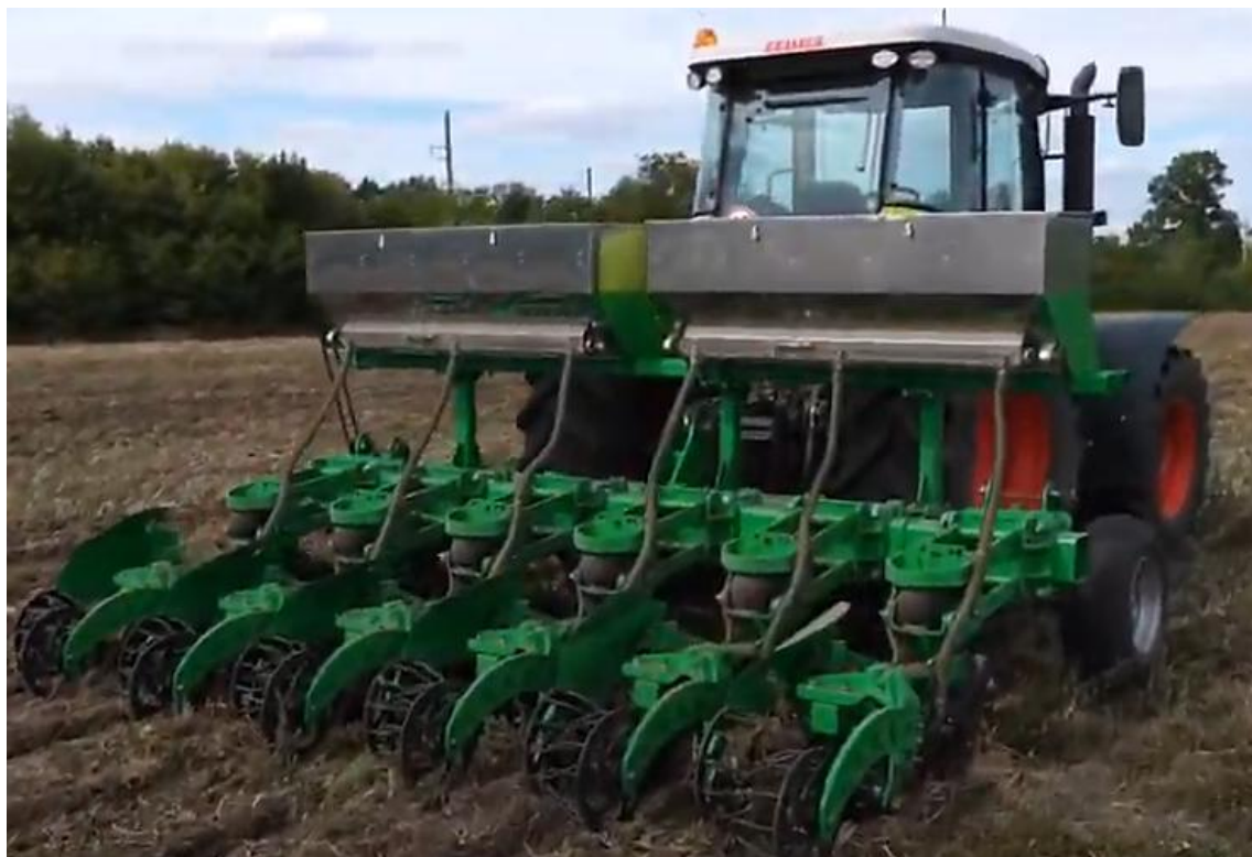
Рисунок 2.2 – Машинно-тракторний агрегат для смугового обробітку на базі трактора Claas та машини Strip-Till KRIOS (Велес-Агро)
