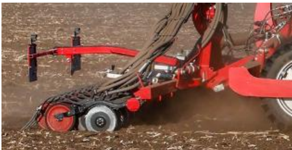
Рисунок 2.8 – Посівні секції TurboDisk комплексу HORSCH Focus 7MT
