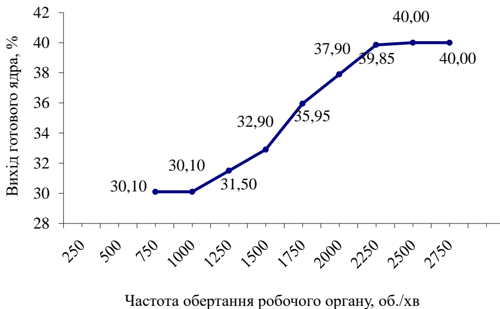
Рис. 7.6. Залежність виходу обрубленого насіння конопель від частоти обертання робочого органа
