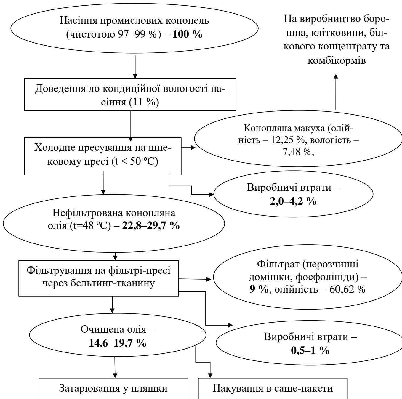
Рис. 7.14. Структурна схема виробництва олії конопляної
