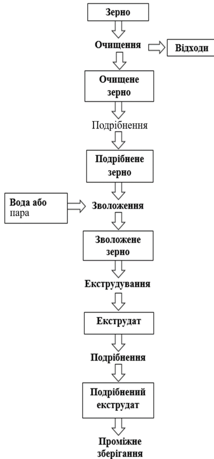
Рис.1.32. Схема матеріальних потоків виробництва зернового екструдату
