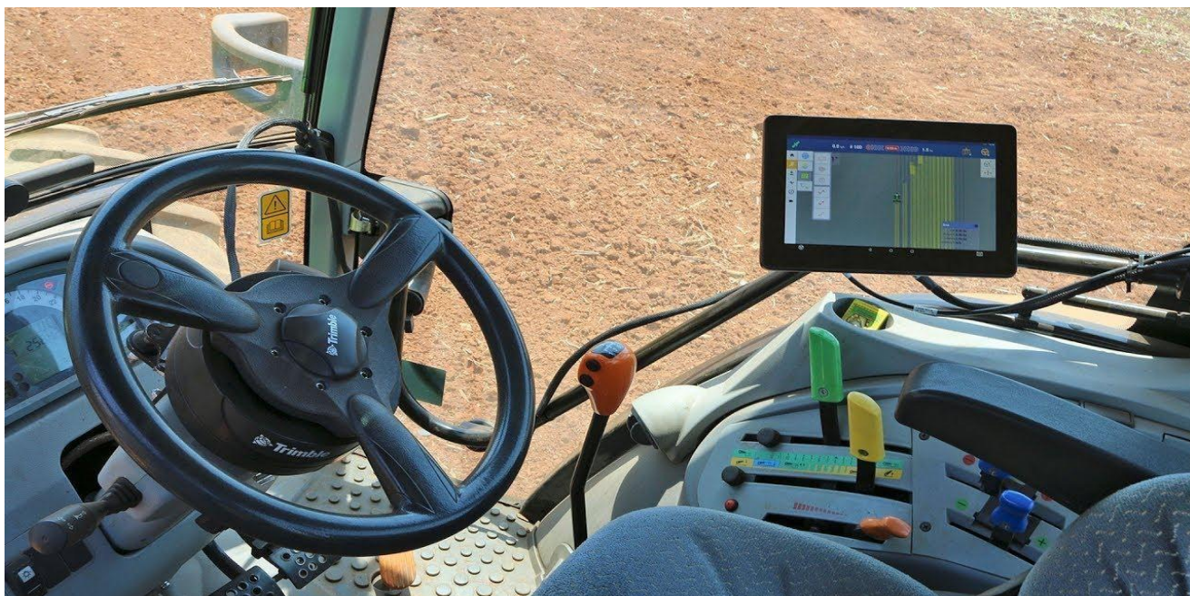
Рис. 5.4. Панель управління сучасного трактора, оснащена елементами автоматичного керування.
