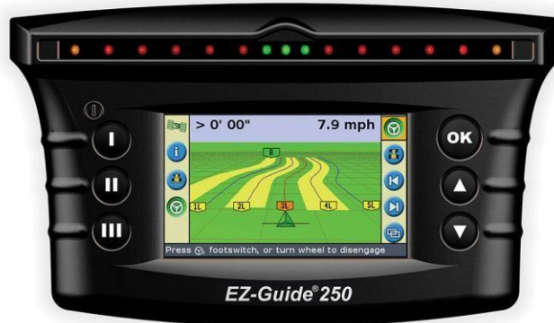
Рис. 5.22. Прилад для паралельного ведення по опорній лінії агрегату.
