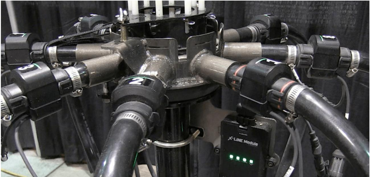
Рис. 5.13. На сівалках, що працюють в системі точного землеробства встановлені датчики потоку.
