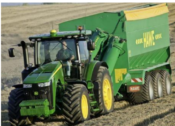
Рис. 5.20. GPS-Антенa встановлена на кабіні трактора.
