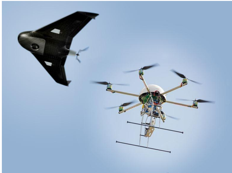
Рис. 5.29. Безпілотні літальні судна за типом літака (планера) та коптер.
