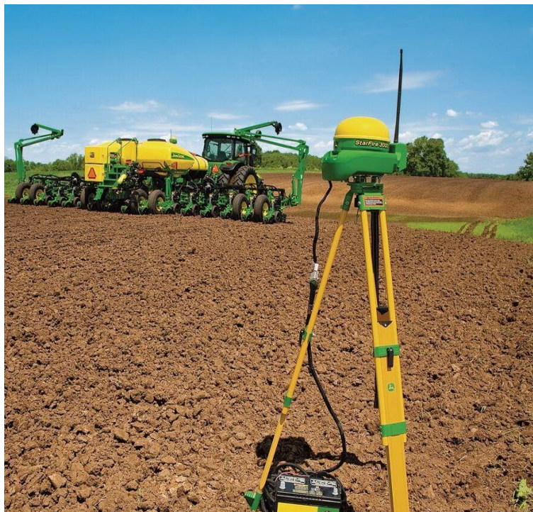
Рис. 5.6. Базова RTK-станція портативного типу.
