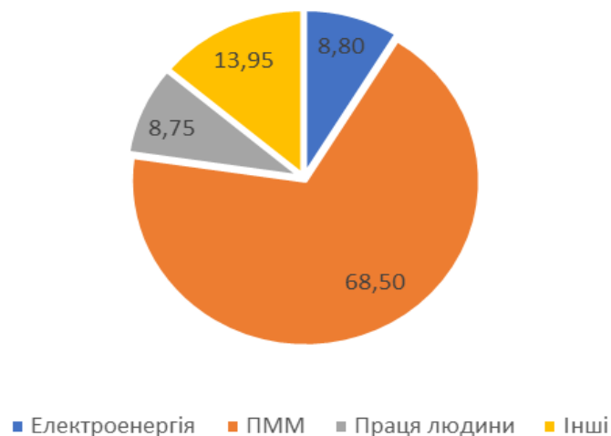
Рис. 3.3 - Баланс енергетичних витрат в структурі енергоємності ТО зернозбирального комбайна John Deere S660.
