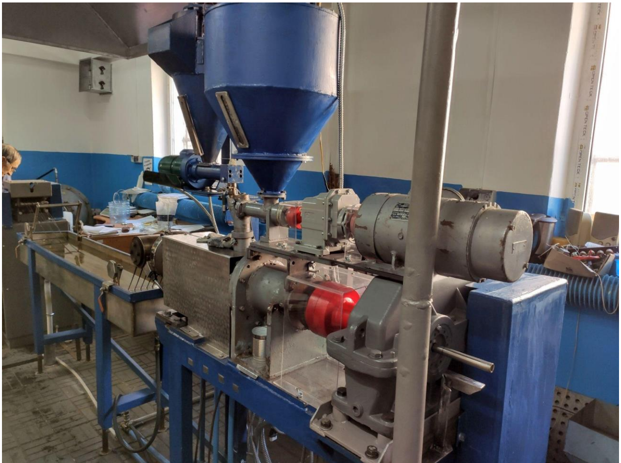
Рисунок 4.1. - Загальний вигляд екструдера ЕКГ-45, встановленого в лабораторії № 018 на діелектричній підлозі та відповідно заземленим.
