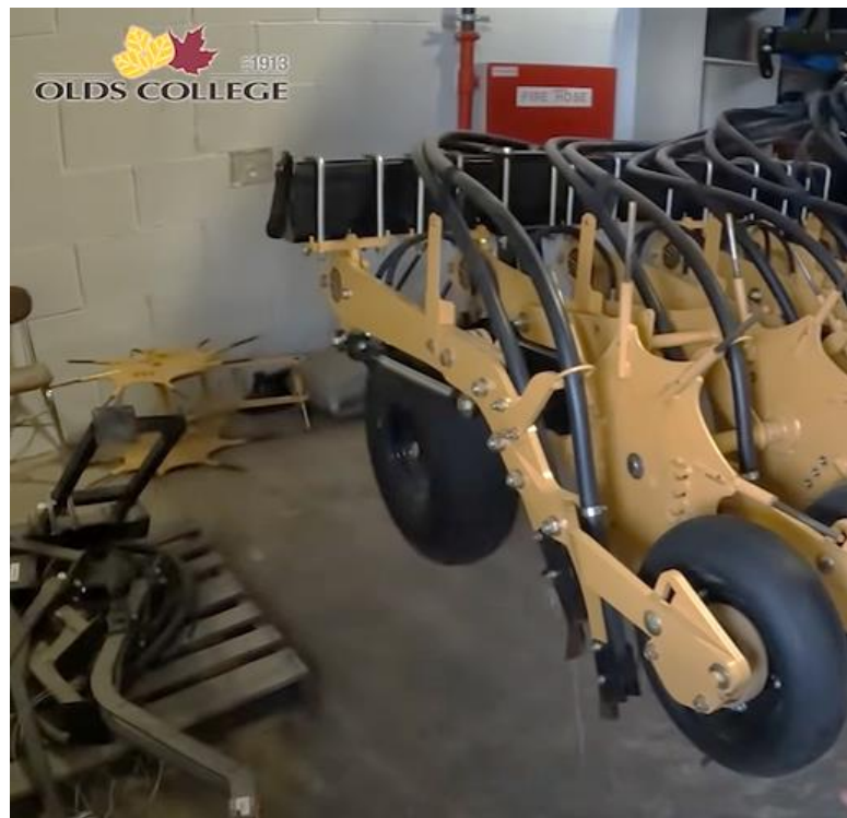
Рис.1.4. Посівні секції, що агрегуються з Autonomous Farm Robot виконані за класичним машинобудуванням.
