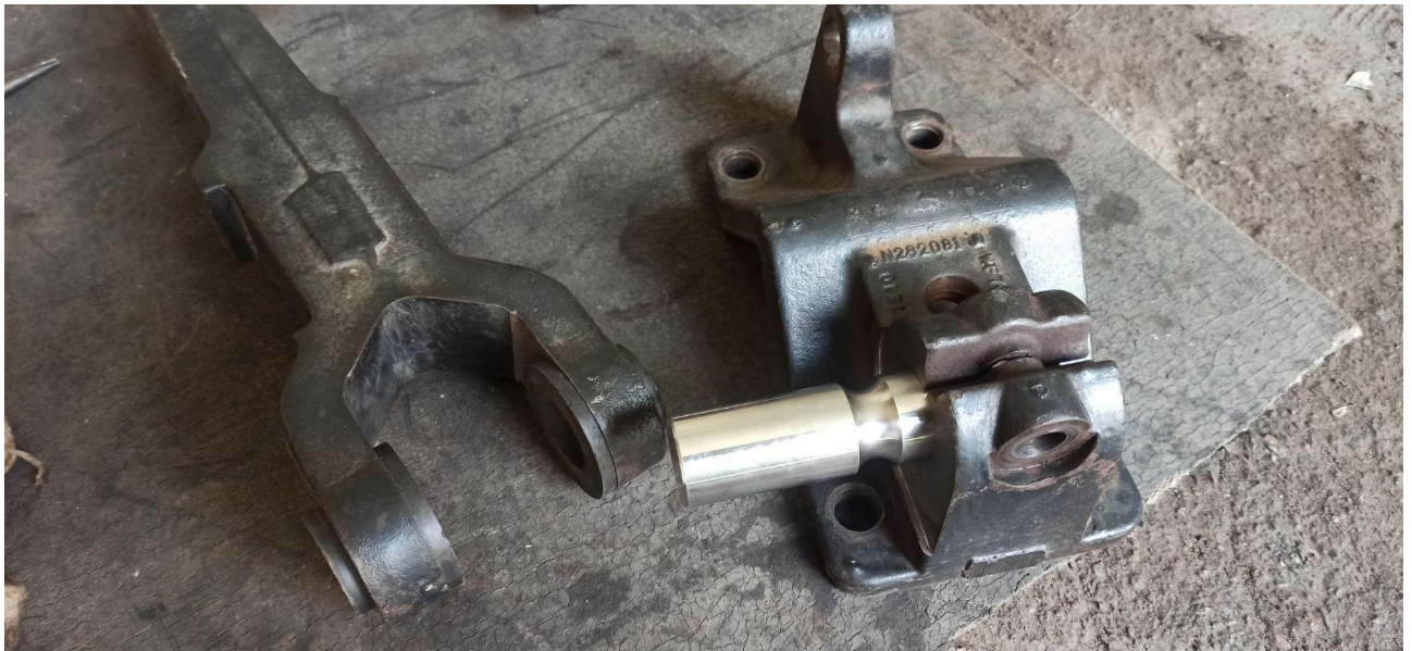
Рисунок 3.9 – Комплектація трибоспряження рухомого з'єднання - важеля прикотного колеса посівного комплексу John Deere 1895.
