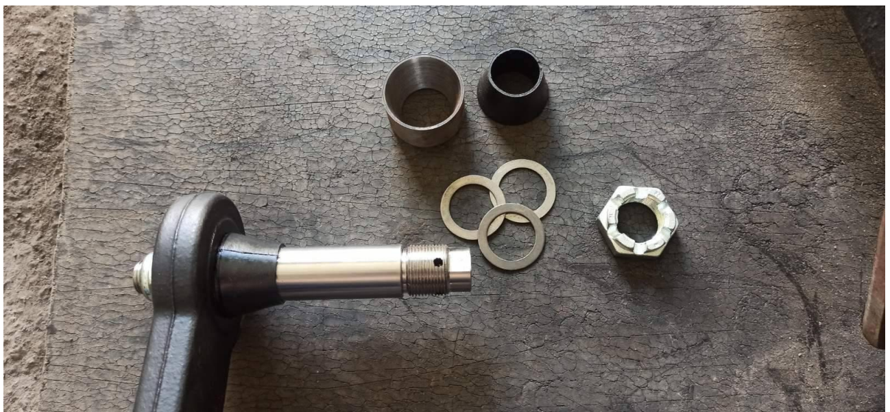
Рисунок 3.11 – Трибоспряження модернізованого важеля прикотного колеса посівного комплексу John Deere 1895.
