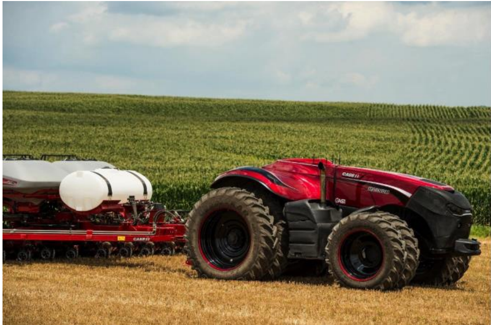
Рис.1.2. Безпілотний трактор класичної тягово-енергетичної концепції.
