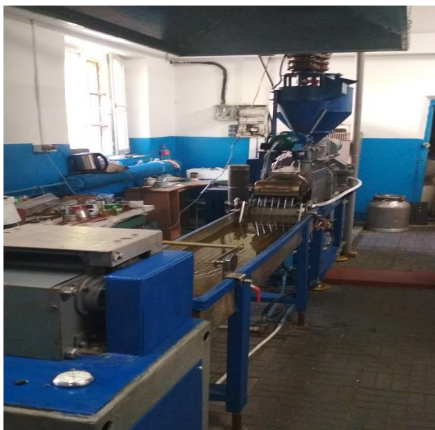
Рисунок 2.3 – Екструдер ЕКГ-45: а – загальний вигляд; б – процес виготовлення ПКМ
