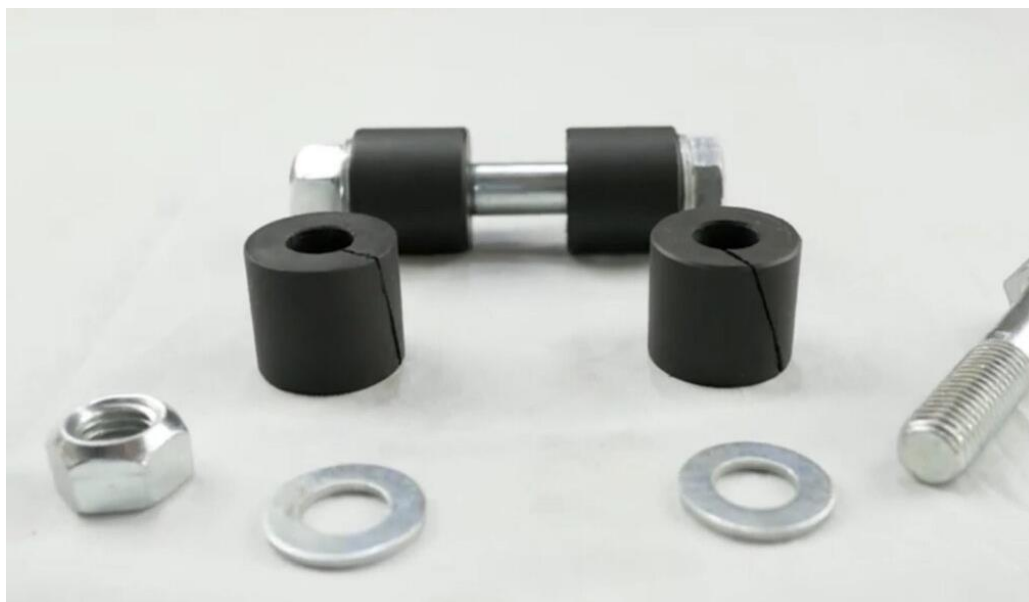
Рисунок 3.11 – Комплект деталей розробленого (модернізованого) рухомого з'єднання прокочуючого механізму сівалки KINZE 3000
