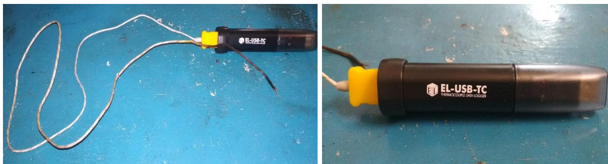
Рисунок 2.8 – Даталогер EL-USB-TC з термопарою: А – загальний вигляд; Б – деталізоване фото даталогера
