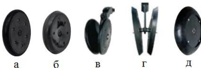
Рис. 1.1 – Типи прикочуючих колес: а – одинарне; б – з ребром по центру; в – подвійне V-подібне; г – клиновидне; д – з гострою вершиною
