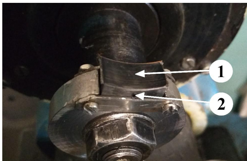
Рисунок 2.7 Зафіксований зразок перед тертям: 1 – зона тертя; 2 – отвір для термопари
