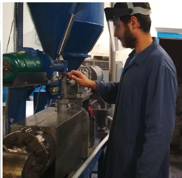
Рисунок 2.3 – Екструдер ЕКГ-45: а – загальний вигляд; б – процес виготовлення ПКМ
