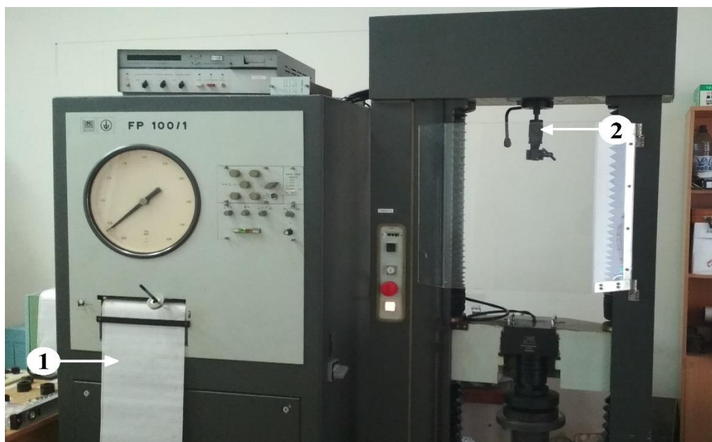
Рисунок 2.5 – Машина для випробувань FP-100/1: 1 – лист для реєстрації результатів; 2 – механізм для випробування на розтяг
