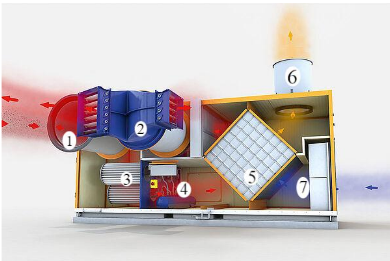
Рисунок 1.12 - Схема роботи установки Earny 2: 1– всмоктуючий патрубок; 2 – нагнітаючий патрубок; 3 – блок фільтрів; 4 – компресорний вузол; 5 – теплообмінник; 6 – вихід відпрацьованого повітря; 7 – вхід свіжого повітря.
