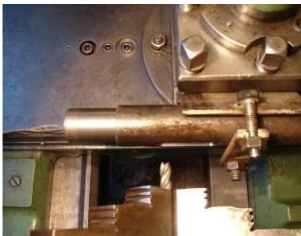
Рис. 3.2. Пристосування для фрезерування шпонкового пазу
