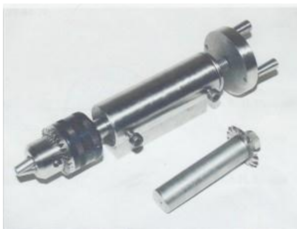
Рис. 3.1. Пристосування для фрезерування шпонкового пазу на токарному верстаті
