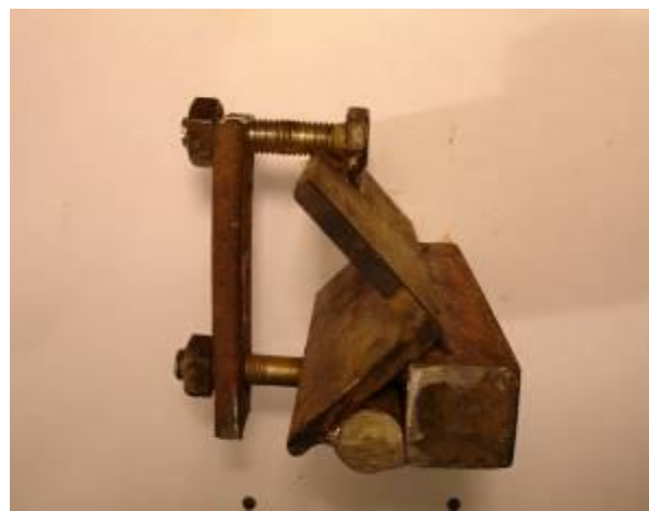
Рис. 3.2. Пристосування для фрезерування шпонкового пазу
