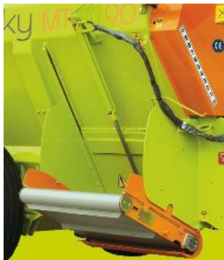
Рисунок 2.1 - Вивантажувальне вікно з транспортером
