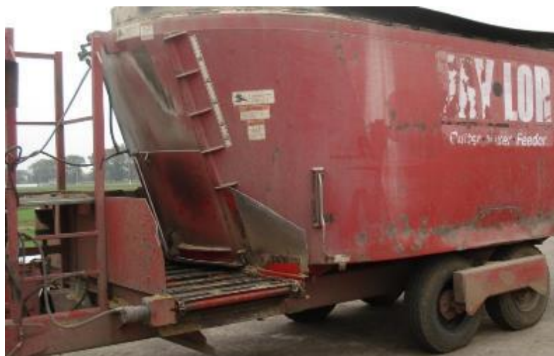
Рисунок 2.1 - Вивантажувальне вікно з транспортером
