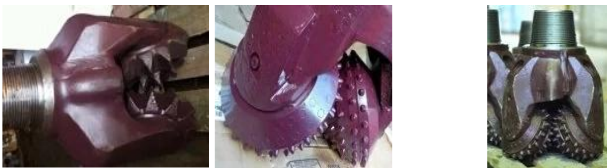
Рисунок 4.2 -Трьох шарошечні долота марок М-ГВ, МС-ГВ, С-ГВ, С-ЦВ, С-ЦГАУ, С-ЦГВУ, МСЗ-ГВУ, СЗ-ГВ, СЗ-ГВУ, діаметром 320 мм
