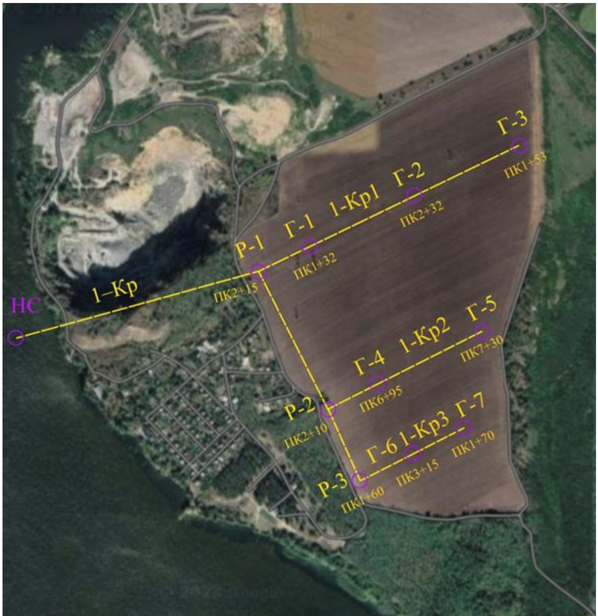
Рисунок 4.2 - Гідротехнічні споруди на зрошувальній мережі
