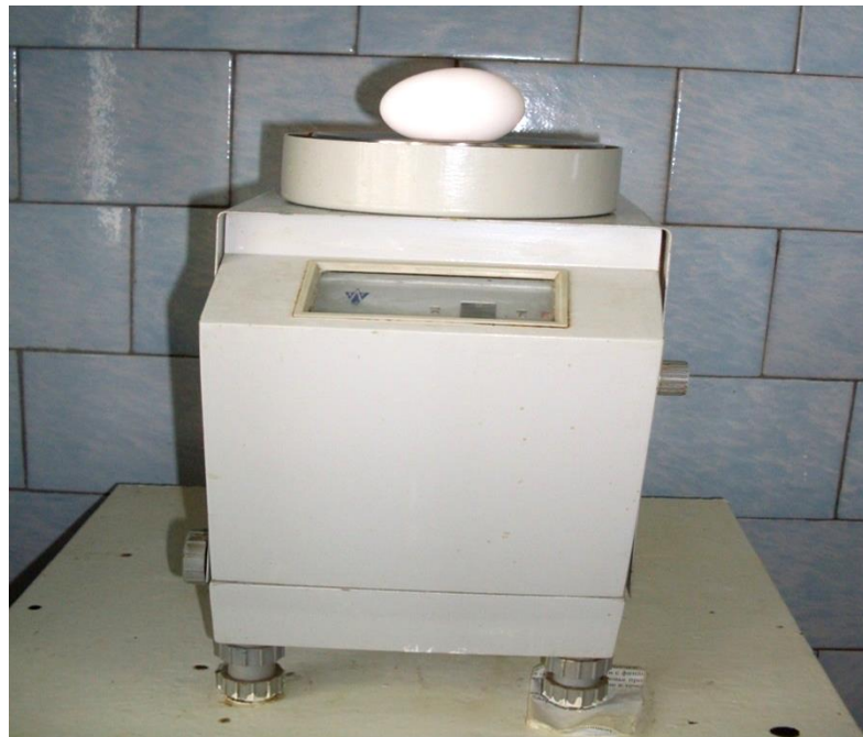
Рис. 19. Зважування яєць на ЗЛГ-500
