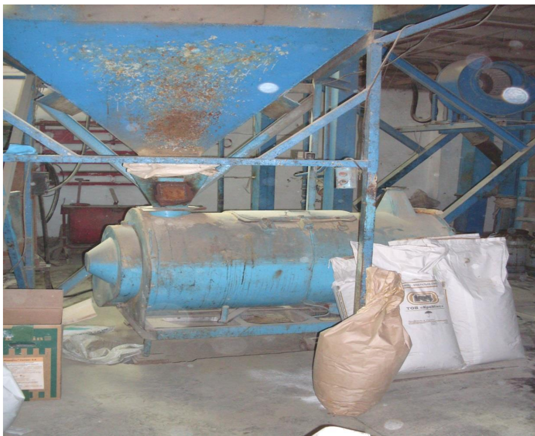
Рис. 6. Обладнання для приготування комбікорму з преміксом
