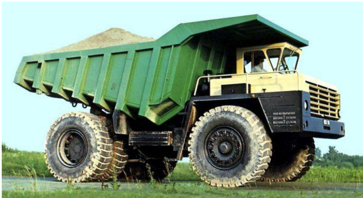
Рисунок 2.8 - Загальний вигляд автосамоскида БелАЗ з кузовом, що має канали обігріву по яким рухаються вихлопні гази автосамоскіда
