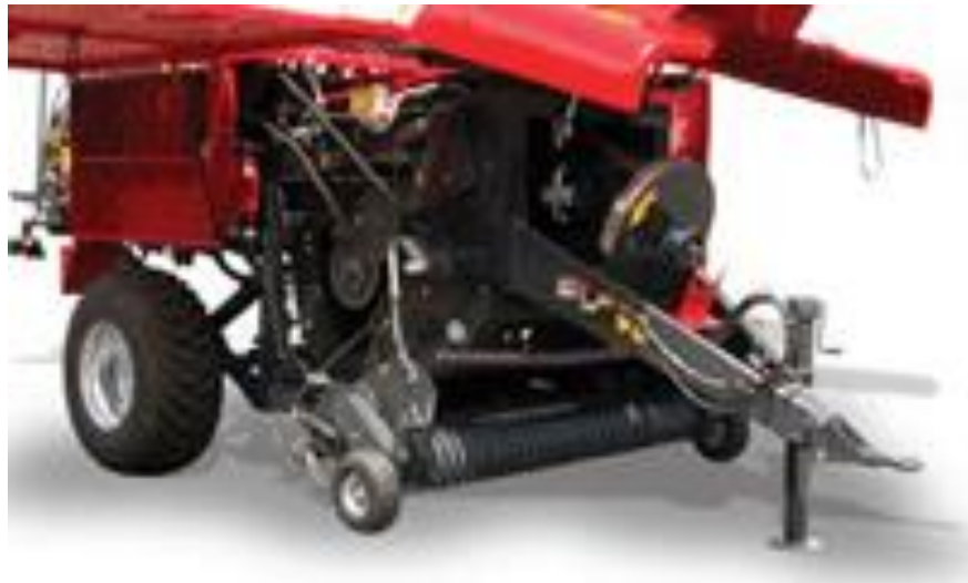
Рисунок 2.7 - Відсік під бухти шпагату прес-підбирача ППТ-1270
