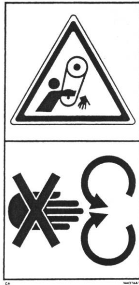
Рисунок 6.1 - Попереджувальний знак, що наноситься на захисний кожух клинопасової передачі приводу ротора.
