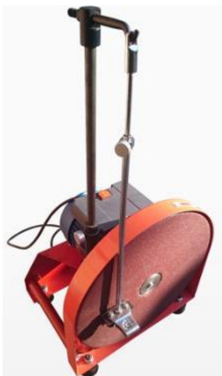
Рисунок 2.7 - Точильний апарат ТА-2М: 1-станина; 2 - електродвигун; 3 - кожух; 4 - стійка; 5 - гачок; 6 - тяга із тримачем; 7 - диск; 8 - піддон
