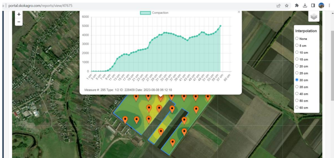
Рис. 2.8. Карти твердості ґрунтів в Skok Agro: а) всього поля на глибині 30 см; б) в окремій точці в діапазоні глибини 0...60 см.
