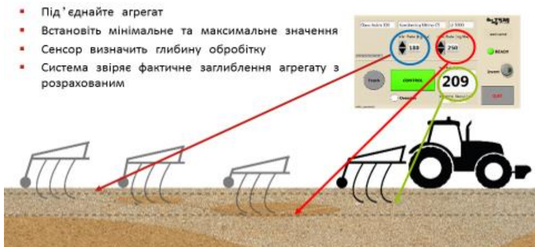
Рис. 3.8. Схема налаштування агрегату на диференційований обробіток ґрунту.
