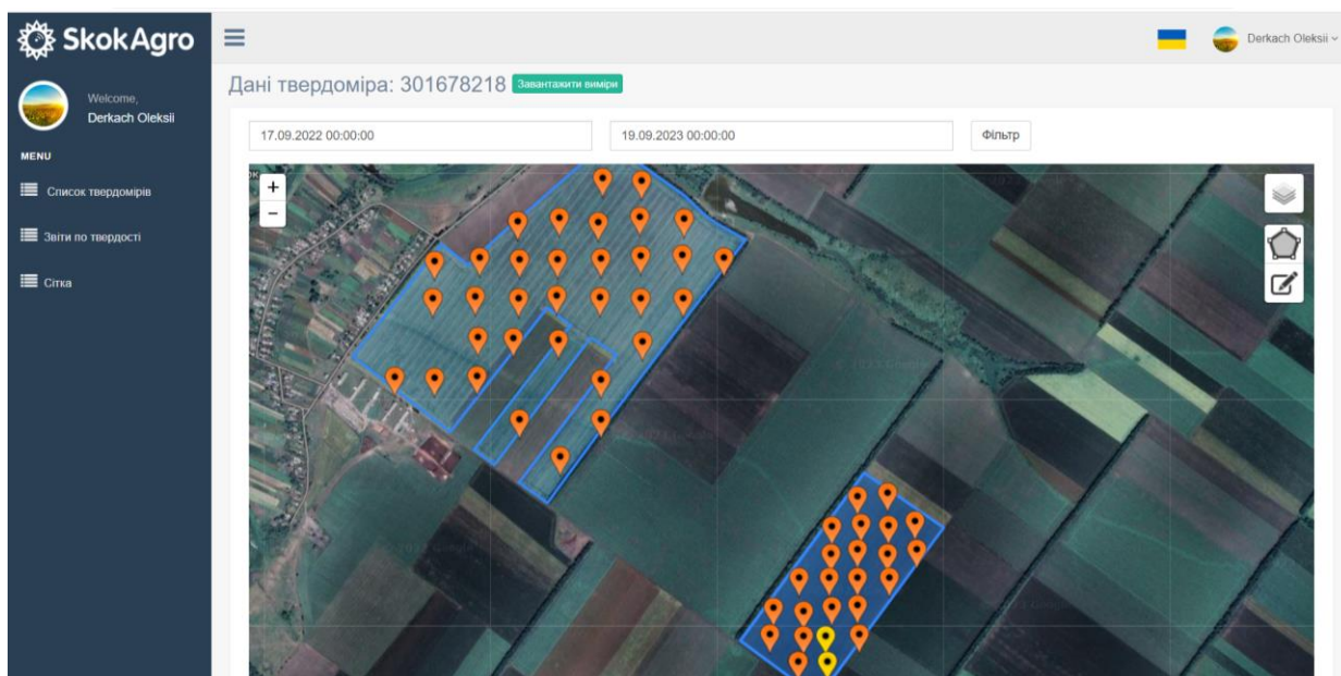
Рис. 3.2. Створення сітки для визначення раціональних точок вимірювання твердості ґрунту на полях ПП «Мир».
