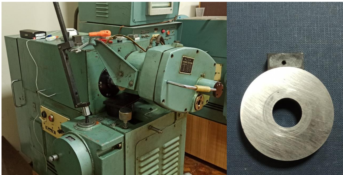
Рисунок 3.3 – загальний вид машини тертя (а), схема роботи (б)
