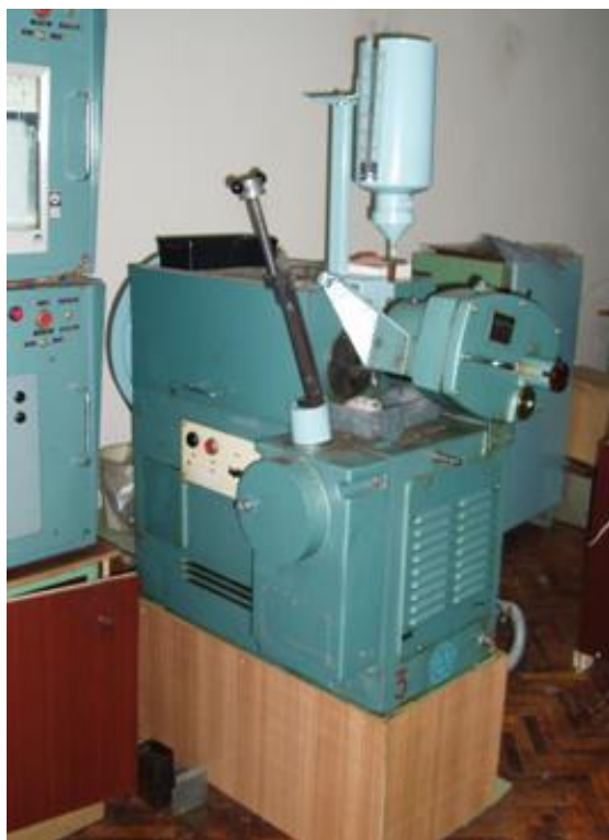
Рисунок 3.8 – Машина для дослідження абразивної стійкості матеріалів СМЦ-2 (1) та схема реалізації процесу (2)
