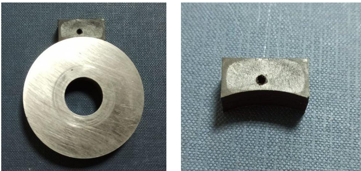
Рис. 3.1 – Зразки для дослідження за схемою диск-колодка
