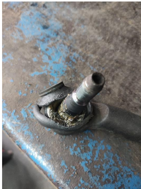
Рис.1.9 – Пошкоджений пильовик рульового наконечника
