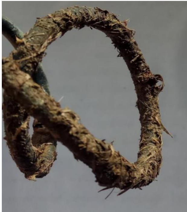
Рисунок 3.3 - Відкладення на зовнішній стінці змійовика
