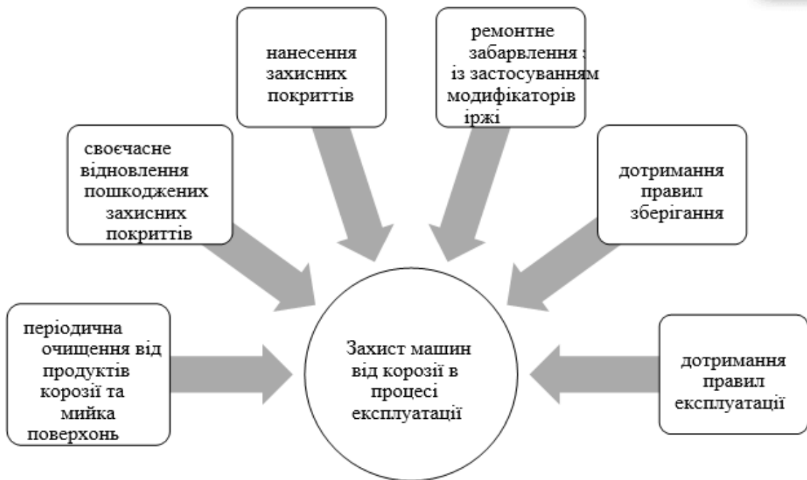
Рисунок 1.18 – Класифікація способів захисту машин та обладнання під час експлуатації
