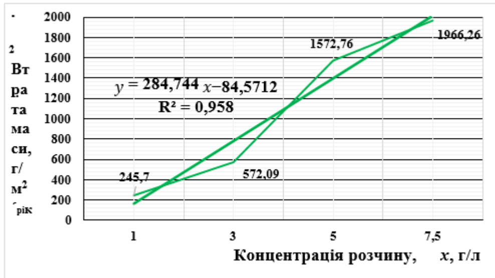
Рисунок 3.2 – Характер залежності корозійних втрат сталі Ст3 від концентрації водного розчину натрію хлориду
