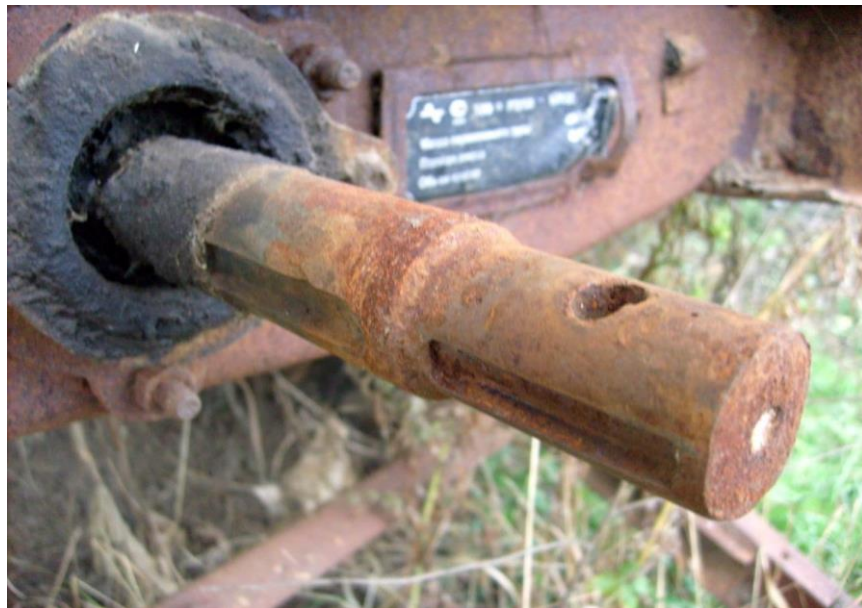
Рисунок 1.10 – Корозія приводного валу роздавача кормів
