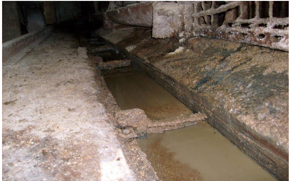
Рисунок 1.8 – Характер корозійного зношування деталей скребкового гноєзбирального транспортера у свинарнику
