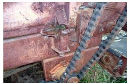
Корозійне ураження деталей втулково-роликів ланцюгів приводу кормороздавача
