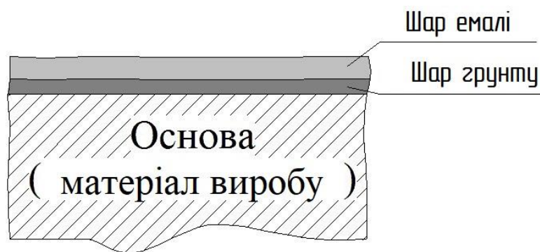
Рисунок 2.2 – Стандартна схема захисного покриття на поверхнях машин та обладнання тваринництва
