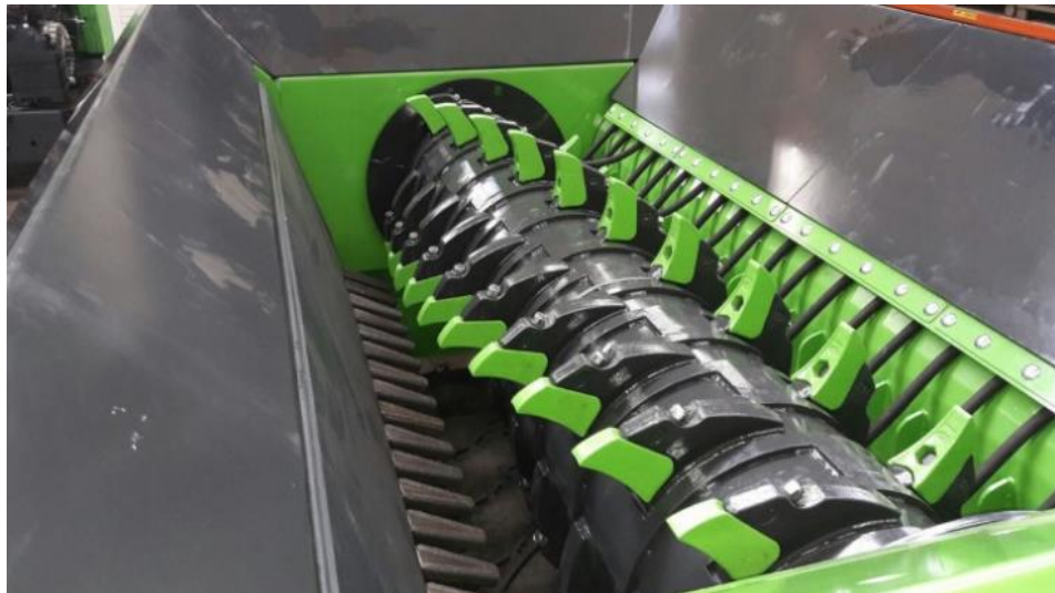
Рис. 1.6. Принципова схема конструкції установки з первинного подрібнення гумотехнічних відходів
