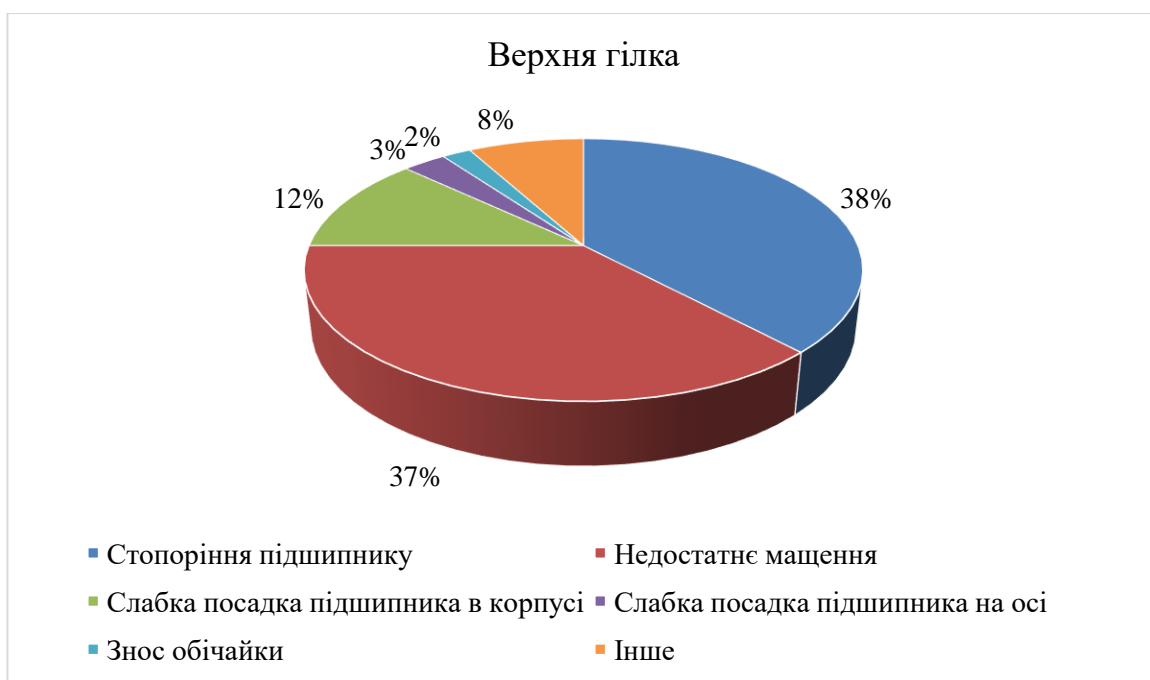
Рис. 1.17. Розподіл відмов верхньої гілки конвеєра
