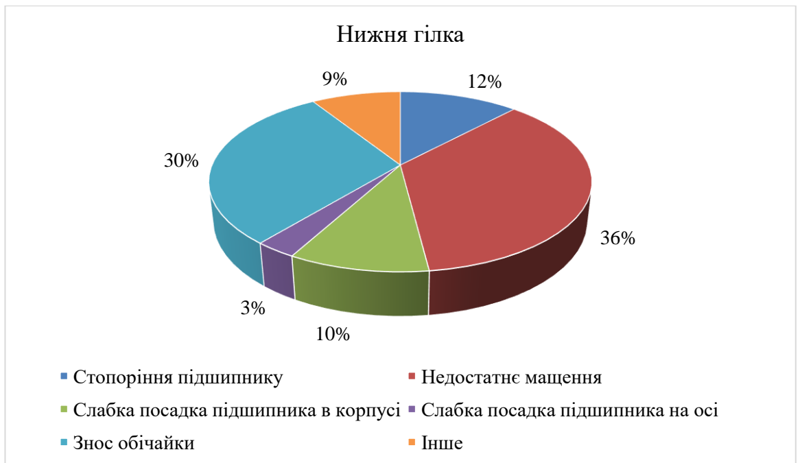
Рис. 1.17. Розподіл відмов нижньої гілки конвеєра
