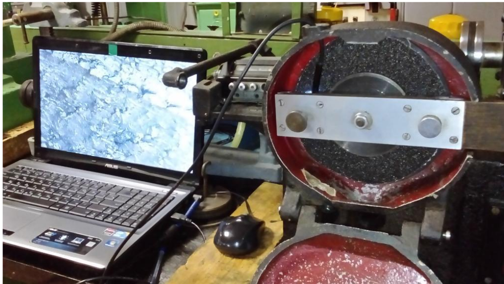
Рис. 3.2 Експериментальна машина тертя
