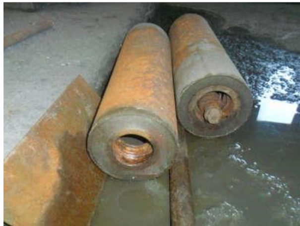
Рис. 1.18. Основні несправності під час роботи конвеєрних роликів
