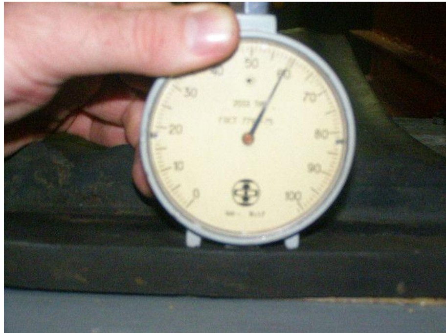
Рисунок 3.6. Замір твердості гуми
