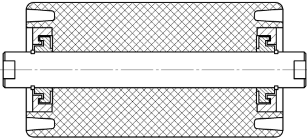
Рис. 3.10. Новий ролик з підшипником ковзання
