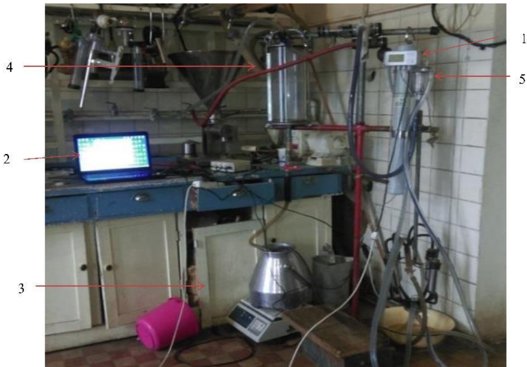
Рисунок 3.2 – Стенд для дослідження продуктивності лічильника-датчика потоку молока.
