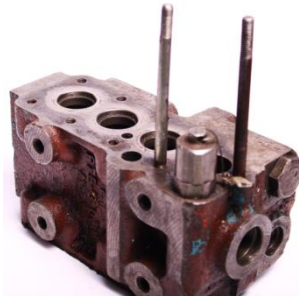
Рис. 4.4. – Гідроабразивне спрацювання робочих поясків корпусу
