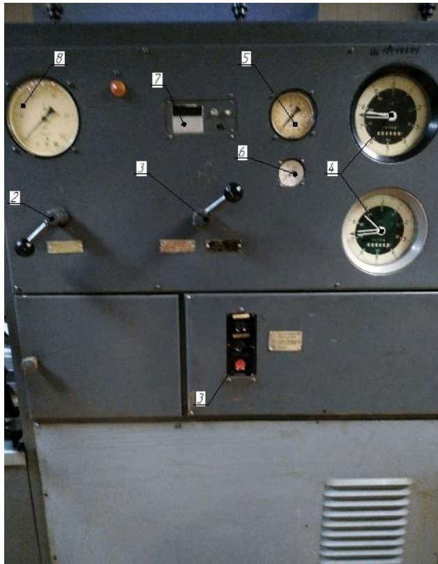
Рис. 3.5. – Розміщення контрольно-вимірювальних приборів на стенді КІ-4815М: 1 – пульт пуску; 2 – дроселя; 3 – ричаг лічильника; 4 – лічильники; 5 – показчик тиску; 6 – показчик температури; 7 – показчик обертів; 8 – манометр
