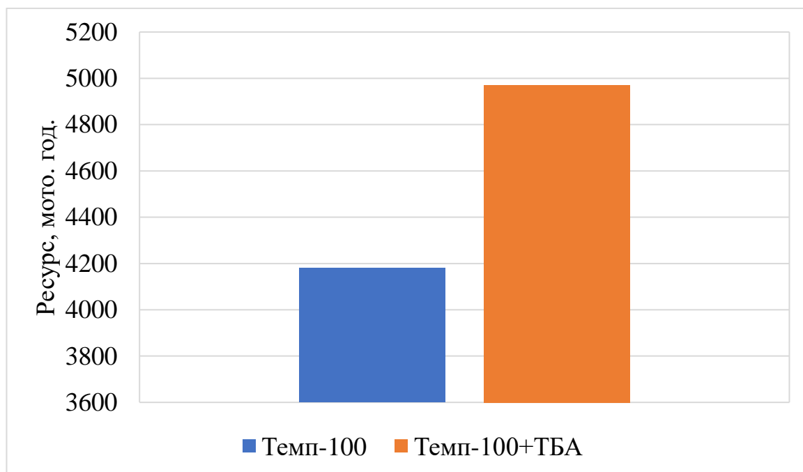
Рис.5.1 – Міжремонтний ресурс двигунів, деталі яких вимиті у 5%-х розчинах:
