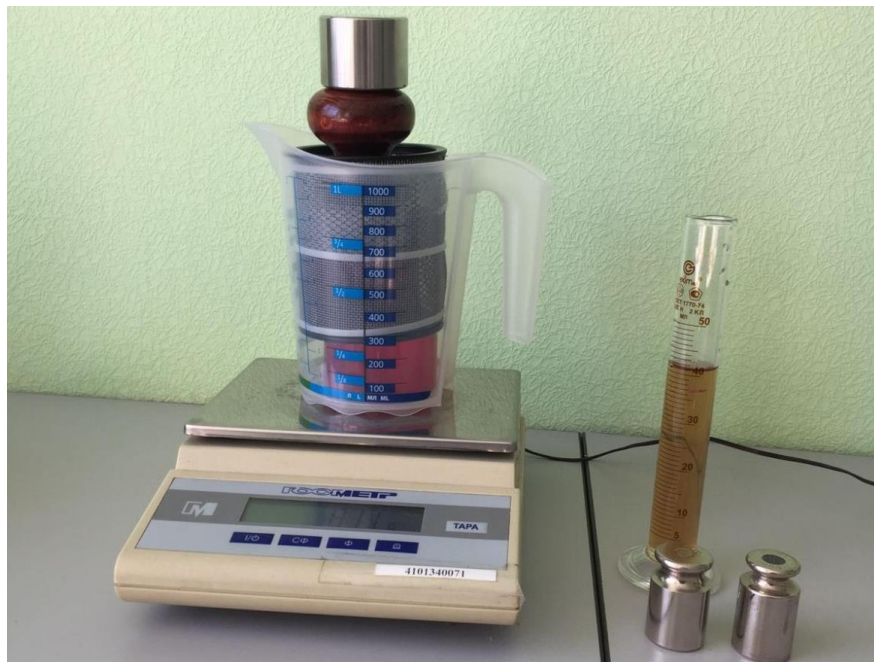
Рисунок 3.5 - Загальний вигляд пристрою визначення тиску пружини в дожимному пристрої щіткового шнека
