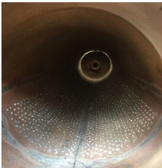
Рисунок 3.10 – Фрагмент перфорованого жолоба
