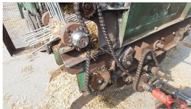
Рисунок 3.4 – Загальний вигляд пальцевого ротору з його приводом
