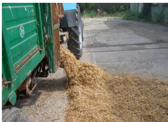
Рисунок 4.5 – Розкидач підстилки в роботі і смуга розкидання
