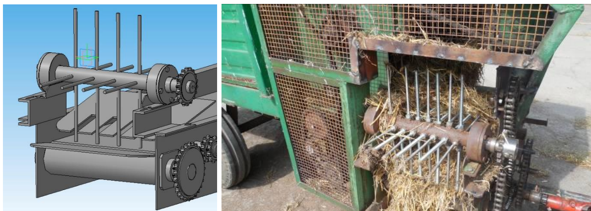
Рисунок 3.2 – Конструктивна модель і загальний вид робочого органу роторно-пальцевого типу
