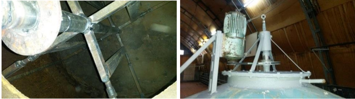
Рисунок 3.5 – Загальний вигляд теплообмінника-змішувача
