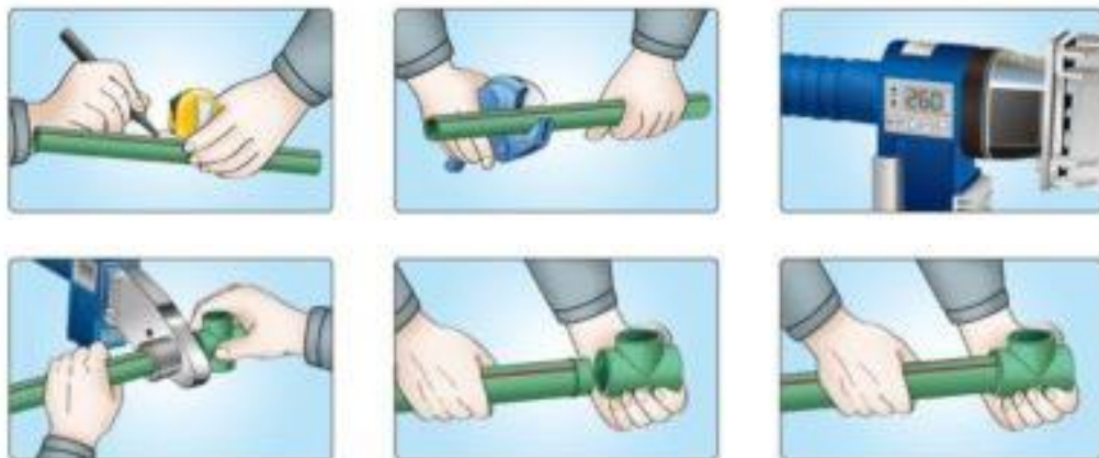
Рисунок 3.3 – Технологічна схема з'єднання (пайка) поліетиленових трубопроводів для систем холодного та гарячого водопостачання: вимірювання; відрізання; нагрів; стикування; витримка до моменту з'єднання.
