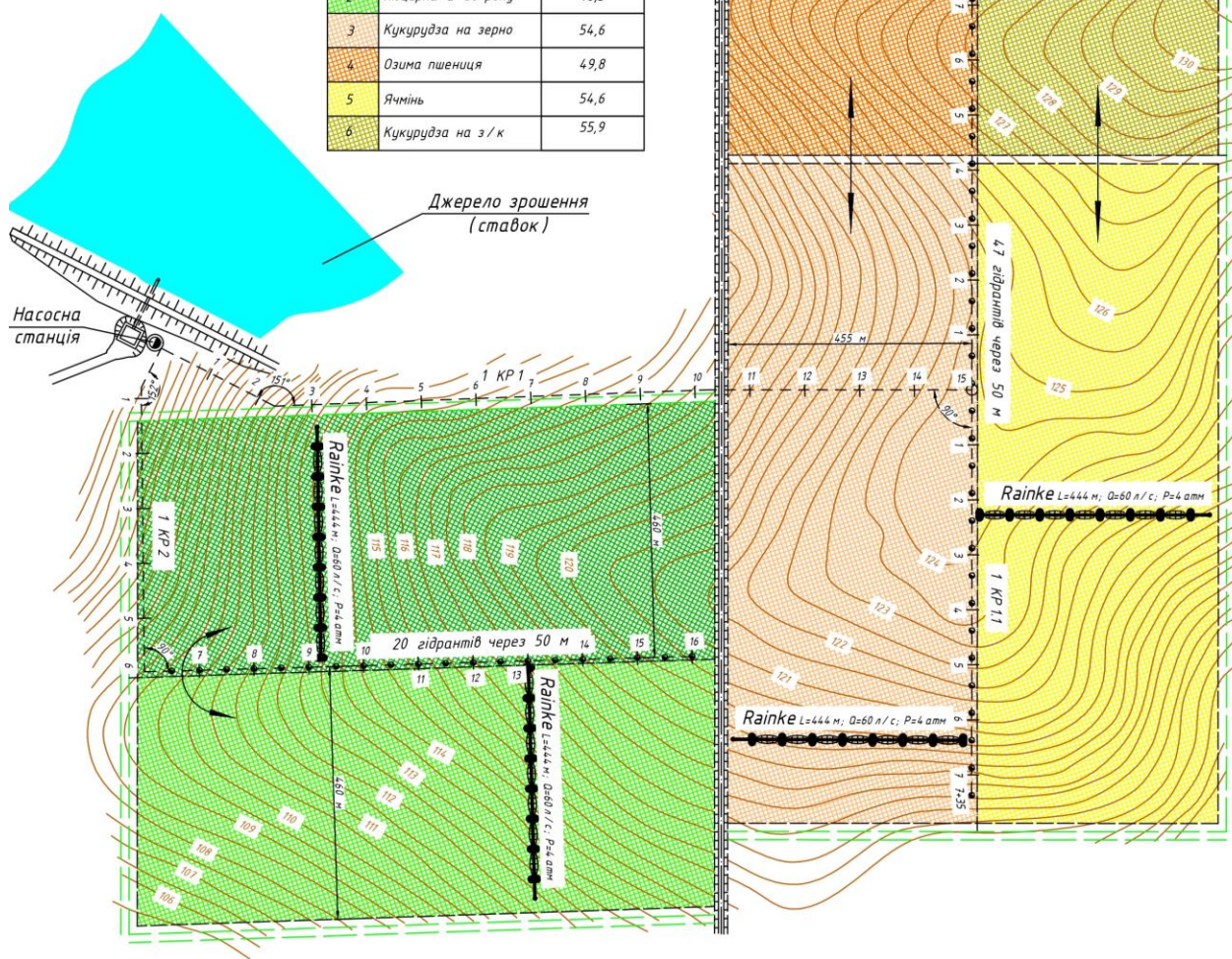
Рисунок 2.10 – Загальний вигляд запроєктованого масиву зрошення
