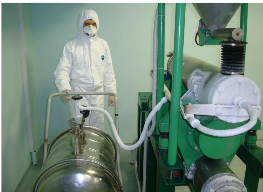
Рисунок 2.2 – Кріовібраційний млин КВМЗ
