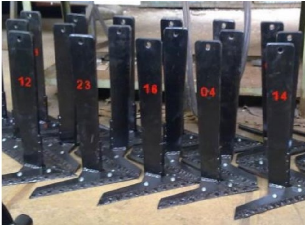
Рис. 1.8 – Культиваторні лапи з локальним нанесенням спеціальних зносостійких наплавних матеріалів [11]
