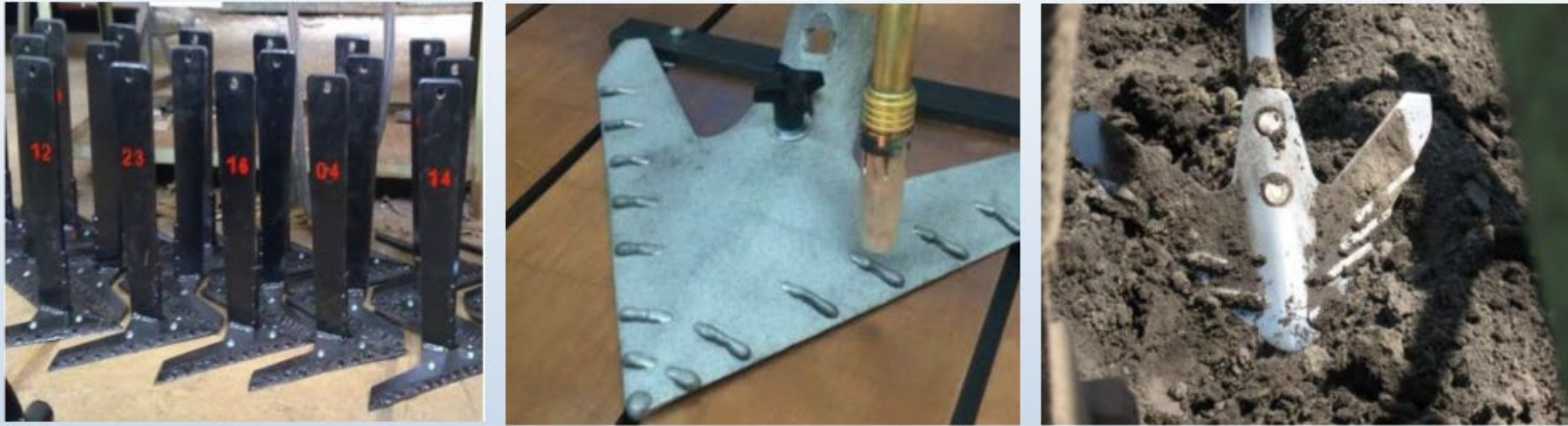
Рис. 4 – Культиваторні лапи із нанесеними локальними зміцнювальними матеріалами
