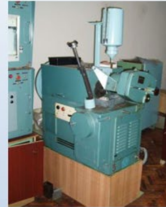
Рис. 8 – Машина СМЦ-2 з устаткуванням для абразивного зношування матеріалів
