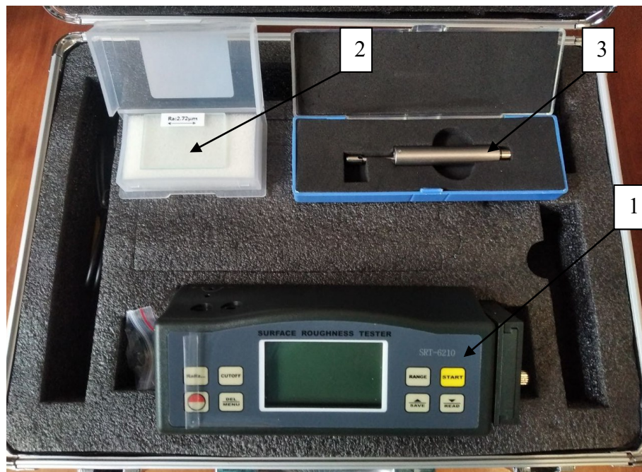
Рисунок 2.2 – Тестер шорсткості Walcom SRT-6210: 1 – основний блок тестера шорсткості, 2 – пластина для калібрування, 3 – датчик тестера.
