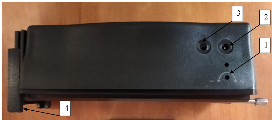
Рисунок 2.4 – Розташування додаткових елементів тестера: 1 – гвинт для калібрування тестера, 2 – вхід для зарядження внутрішньої батареї, 3 – роз’єм під’єднання до ПК, 4 – упор для встановлення тестера в горизонтальне положення
