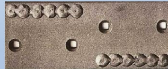
Рис. 6 – Польова дошка із нанесеними зміцнювальними матеріалами
