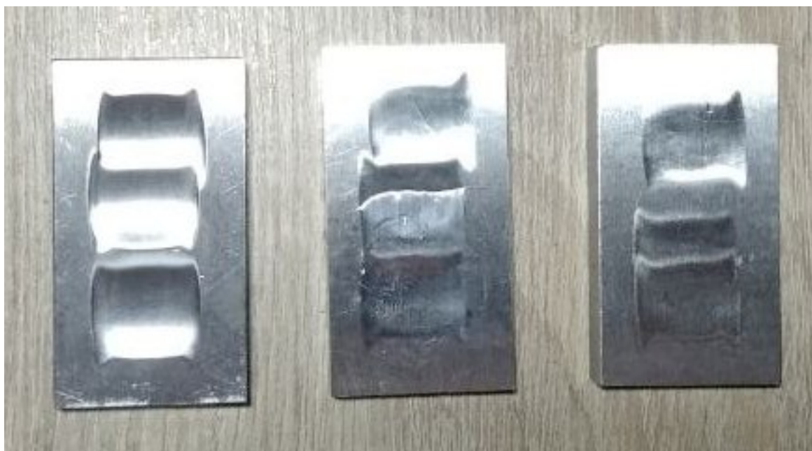
Рисунок 3.2 – Зразки після примусового абразивного зношування: а – зразок 1, б – зразок 2, в – зразок 3.
