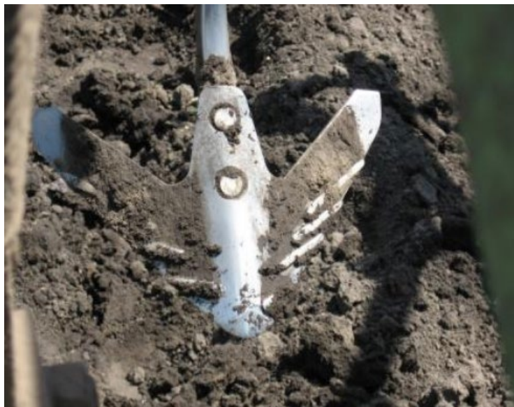
Рис. 1.10 Культиваторна лапа зі елементами зміцнення та ґрунтом, що налипає [13]
