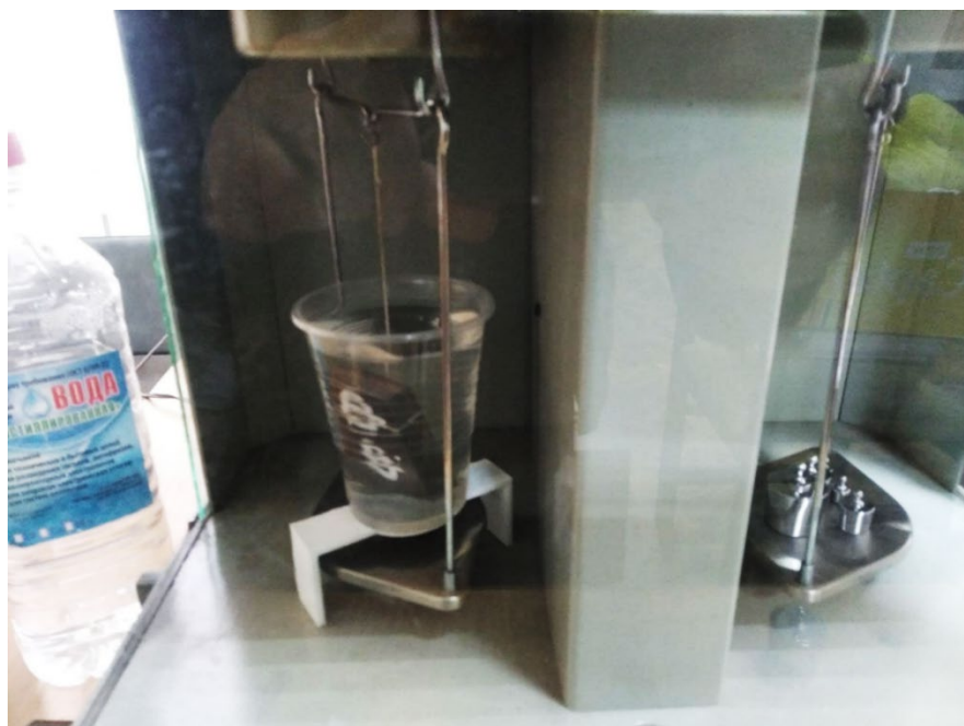
Рисунок 3.1 – Визначення маси зразку зануреного у дистильовану воду
