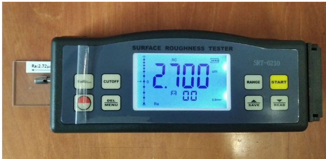
Рисунок 2.3 – Процес перевірки правильності результатів визначення шорсткості поверхні тестером (калібрування)
