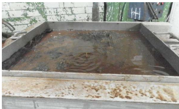
Рисунок 4.15 – Зразок за 5 хв починає слабо звальватися, перевертаємо зразок
