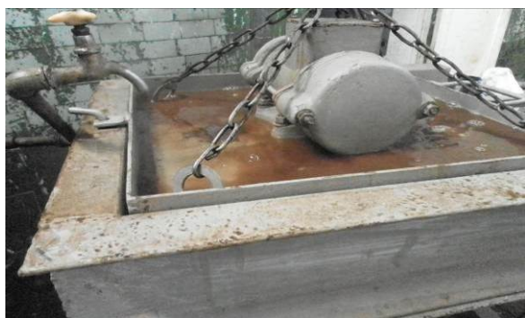
Рисунок 4.12 – Ставимо верхню плиту з вібратором, вимірюємо температуру миючого розчину (+70°C)
