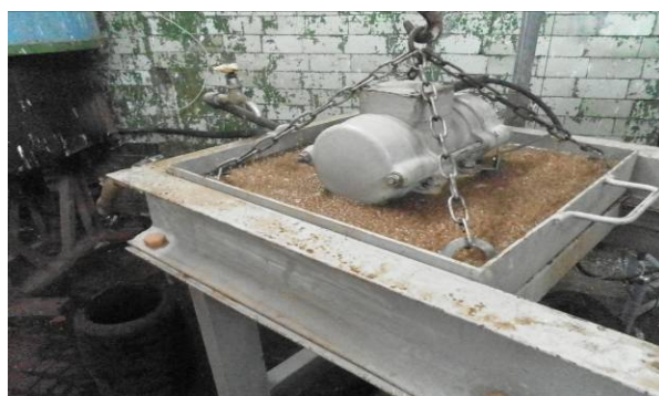
Рисунок 4.13 – Вимірюємо температуру води на вході і починаємо валяння вовни
