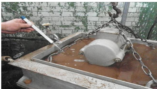
Рисунок 4.13 – Вимірюємо температуру води на вході і починаємо валяння вовни
