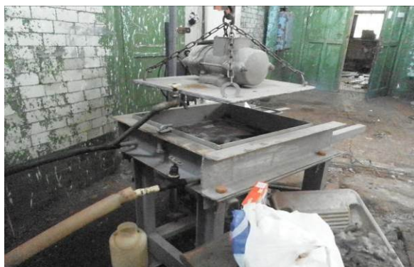
Рисунок 4.8 – Підвід гарячої води в піддон через кран і до батареї, стік води – через пластикові труби
