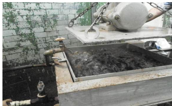
Рисунок 4.11 – Рівномірно розподіляємо вовну на площі піддону і ставимо верхню плиту з вібратором
