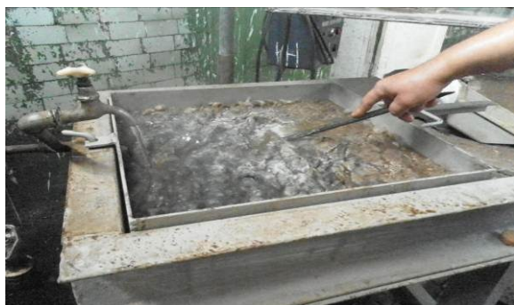
Рисунок 4.11 – Рівномірно розподіляємо вовну на площі піддону і ставимо верхню плиту з вібратором
