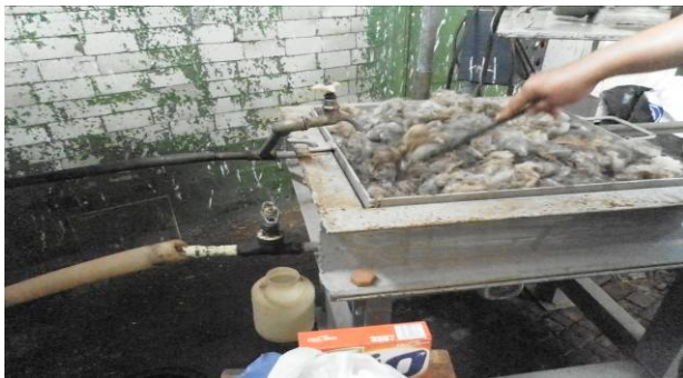
Рисунок 4.10 – Замочування вовни гарячою водою з миючим засобом
