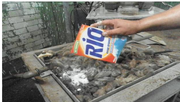
Рисунок 4.10 – Замочування вовни гарячою водою з миючим засобом
