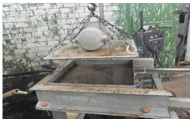
Рисунок 4.14 – Вовна одночасно валяється і миється, піднімаємо верхню плиту
