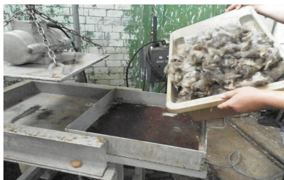
Рисунок 4.9 – Завантаження вовни та перевірка рівномірності тріпання вовни, укладаємо вовну в піддон
