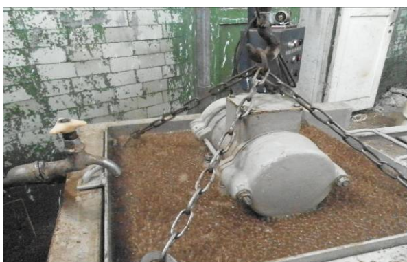
Рисунок 4.14 – Вовна одночасно валяється і миється, піднімаємо верхню плиту
