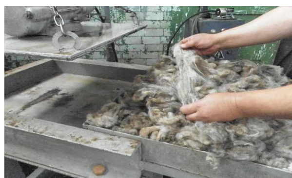
Рисунок 4.9 – Завантаження вовни та перевірка рівномірності тріпання вовни, укладаємо вовну в піддон
