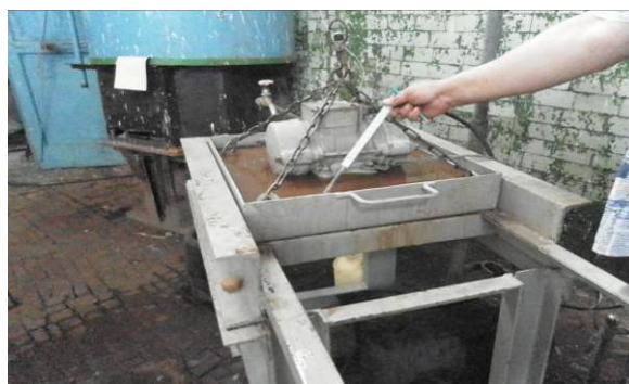
Рисунок 4.12 – Ставимо верхню плиту з вібратором, вимірюємо температуру миючого розчину (+70°C)
