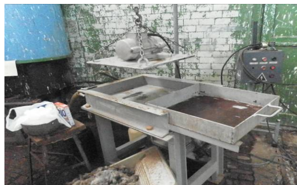
Рисунок 4.8 – Підвід гарячої води в піддон через кран і до батареї, стік води – через пластикові труби
