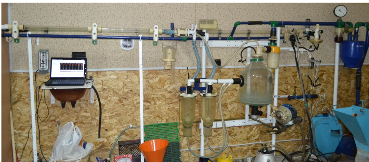
Рисунок 3.2 Схема (а) і загальний вид установки (б) для дослідження режимів мийки молокопроводу
