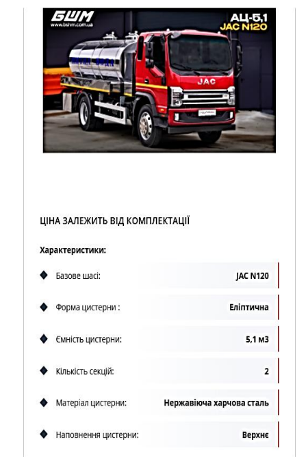
Рис. 3.11. Основні характеристики вантажного автомобіля з перевезки ВОДИ (джерело: [1]).
