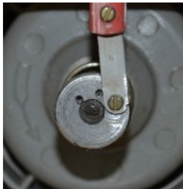
Рисунок 3.1 – Експериментальний вібраційний змішувач (а) та ексцентрик зі змінним ексцентриситетом (б): 1 – бункер змішувача; 2 – віброднище; 3 – ексцентрик; 4 – частотний регулятор Mitsubishi S 500; 5 - електродвигун АІР 56 А2; 6 - ПЕОМ
